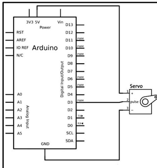
**Ejemplo 5.15:** El siguiente código mueve de forma continua el eje del servomotor desde un ángulo de 0 grados hasta 180 y seguidamente lo mueve en sentido contrario de 180 grados a 0, y así ininterrumpidamente.
