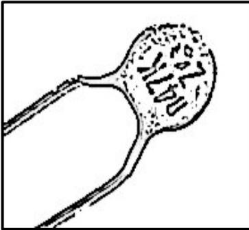
Los condensadores unipolares (no polarizados) pueden conectarse al circuito en ambos sentidos indiferentemente (al igual que las resistencias, por ejemplo). Pueden estar fabricados de muchos materiales, pero los más comunes son los de tipo cerámico (como el mostrado en la imagen). Por lo general, suelen tener una capacidad bastante menor que los condensadores polarizados.
