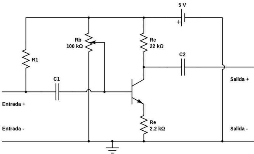
Tanto este circuito como el anterior tienen la ventaja de amplificar la señal sin distorsión, pero tiene el inconveniente de que aporta constantemente un colchón DC a la base del transistor, con lo que no es un circuito eficiente energéticamente.
