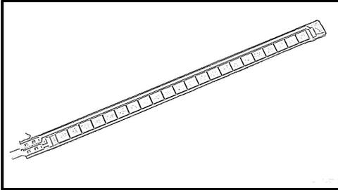
Unos sensores parecidos a los FSR son los sensores de flexión (en inglés llamados “flex sensors” o “bend sensors”). Estos sensores están compuestos por una tira resistiva flexible solo en una dirección. Su resistencia cambia según cuánto sea arqueada: si están en equilibrio (es decir, sin combarse) su resistencia es mínima y
