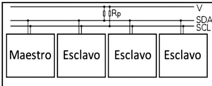
Tal como se muestra en el diagrama anterior, para funcionar correctamente tanto la línea “SDA” como la “SCL” necesitan estar conectadas mediante una resistencia “pull-up” a la fuente de alimentación común, la cual puede proveer un voltaje generalmente de 5 V o 3,3 V (aunque sistemas con otros voltajes pueden ser posibles).
