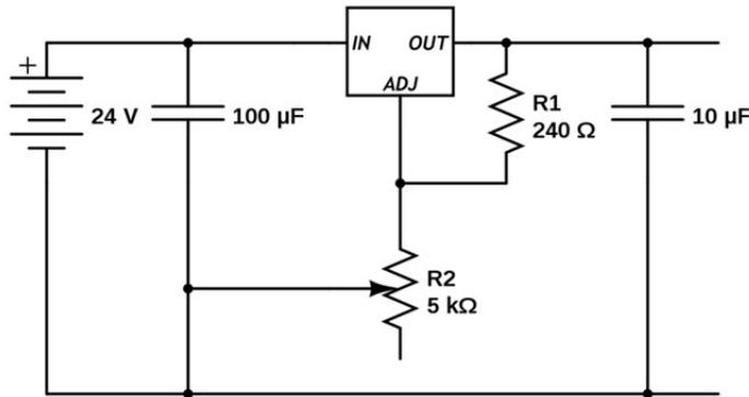
Usando el LM317 y el circuito mostrado en el esquema anterior, obtendremos un voltaje de salida dado por la expresión  $V_{salida} = 1,25 \cdot (1 + R2/R1)$ . Opcionalmente, al diseño anterior se le puede añadir un diodo para proteger el regulador contra posibles cortocircuitos en su entrada; para ello, deberíamos conectar el ánodo del diodo a la patilla de salida y el cátodo a la patilla de entrada.
