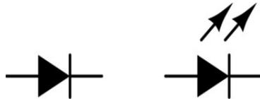
El vértice del triángulo secante con la línea perpendicular de ambos símbolos representa el cátodo. Existen otros símbolos similares que representan diodos más específicos (como los de tipo Zener o Schottky, entre otros) pero no los veremos.
