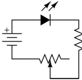
Tenemos que imaginar que la flecha central del símbolo del potenciómetro se moverá desde un extremo hasta el otro de ese símbolo según giremos la rosca del potenciómetro. Tal como está dibujado el esquema anterior, si la flecha se “sitúa” en el extremo derecho del símbolo, el potenciómetro funcionará con su valor de resistencia máximo; si la flecha se “sitúa” en el extremo izquierdo, el potenciómetro no ofrecerá resistencia alguna.
