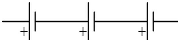
La conexión en serie de baterías es útil cuando necesitamos tener una batería que genere un determinado voltaje relativamente elevado (por ejemplo, 12 V) y solo disponemos de pilas de menor voltaje (por ejemplo, de 1,5 V). En ese caso, podemos conectar dichas unidades de 1,5 V en serie para obtener "a mano" la batería que aporte el voltaje deseado, ya que el voltaje total aportado por baterías conectadas en serie es la suma de sus voltajes individuales. En nuestro ejemplo, para obtener 12 V a
