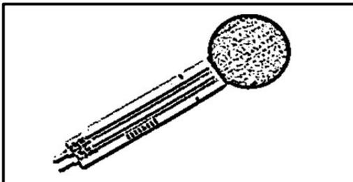
Estos sensores (también llamados FSRs, del inglés, “Force Sensitive Resistor”) permiten detectar fuerza. Son básicamente un resistor que cambia su resistencia dependiendo de la fuerza a la que es sometido (concretamente, su resistencia disminuye a mayor fuerza recibida). Estos sensores son muy
