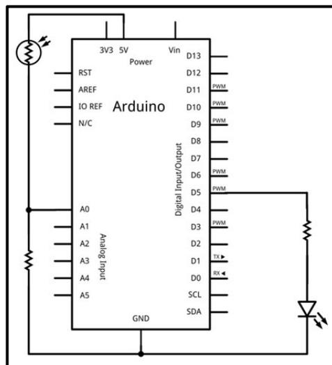
Lo que queremos es utilizar el valor del voltaje leído en el pin de entrada analógico (el nº 0 en este caso) para iluminar consecuentemente el LED: cuanto menos luz detecte el fotorresistor, más brillante iluminará el LED (por eso es necesario que el LED reciba una señal analógica también, a través de un pin PWM, el nº 5 en este caso). Además, se muestra por el canal serie los valores obtenidos por el fotorresistor.
