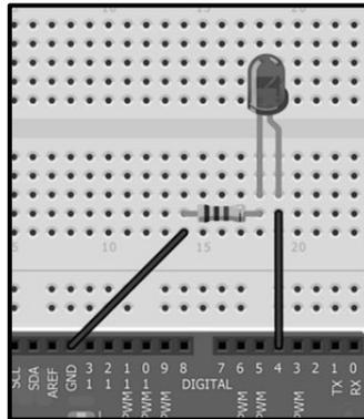
En él se puede observar que el terminal positivo del LED está conectado al pin-hembra digital número 4 de la placa Arduino y su terminal negativo está conectado a una resistencia que hace de divisor de tensión (un valor de 220 ohmios ya estaría bien), la cual está conectada a su vez a tierra.
