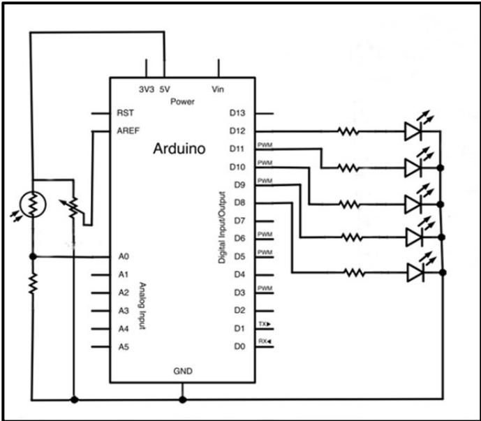
Un valor adecuado para los divisores de tensión de los LEDs puede ser  $220\ \Omega$ . Un valor adecuado para la resistencia “pull-down” asociada al LDR puede ser de  $1\ \text{K}\Omega$ . Un valor adecuado para la resistencia máxima del potenciómetro puede ser  $10\ \text{K}\Omega$ . El LDR, tal como se puede ver, está conectado al pin de entrada analógica nº 0.
