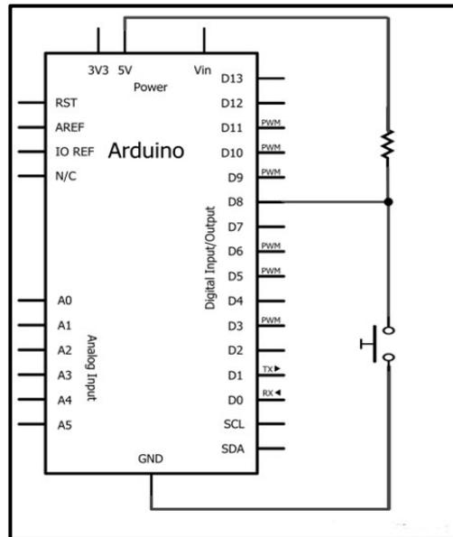
Aquí podemos comprobar cómo las conexiones del pulsador son por un lado a la alimentación a través de la resistencia “pull-up” (pongamos que de 10 KΩ) y por otro directa a tierra. Existe un tercer cable, conectado entre el pulsador y la resistencia que va a parar a un pin digital de la placa Arduino (en este caso particular,
