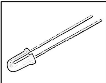
Un fotodiodo es un dispositivo que, cuando es excitado por la luz, produce en el circuito una circulación de corriente proporcional (y medible). De esta manera, pueden hacerse servir como sensores de luz, aunque, si bien es cierto que existen fotodiodos especialmente sensibles a la luz visible, la gran mayoría lo son sobre todo a la luz infrarroja. Se pueden adquirir en cualquier distribuidor de componentes
