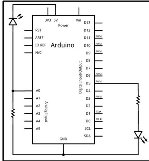
Hemos añadido un LED conectado al pin de salida PWM nº 5 tal como hicimos cuando vimos los LDRs para tener una manera visible (nunca mejor dicho) de detectar la incidencia de luz infrarroja sobre el fotodiodo. Tal como se puede observar en el código utilizado (mostrado a continuación), hemos hecho depender la intensidad del brillo del LED de la cantidad de luz infrarroja detectada por el fotodiodo: cuanta más radiación infrarroja se reciba, más iluminado estará el LED.
