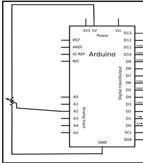
Si ejecutamos el siguiente sketch y movemos el potenciómetro, veremos por el “Serial monitor” las lecturas realizadas a través del pin analógico 2, que no son más que valores entre 0 y 1023. Notar que no se ha utilizado la función *pinMode()* como hasta ahora porque los pines-hembra analógicos de la placa Arduino solo pueden ser de entrada.
