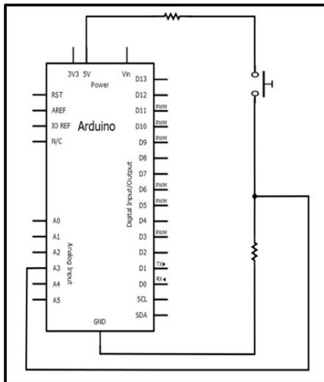
En el caso de haber utilizado la configuración del pulsador con resistencias “pull-up”, entonces deberíamos haber colocado el divisor de tensión entre tierra y la patilla del pulsador conectada a esta.
