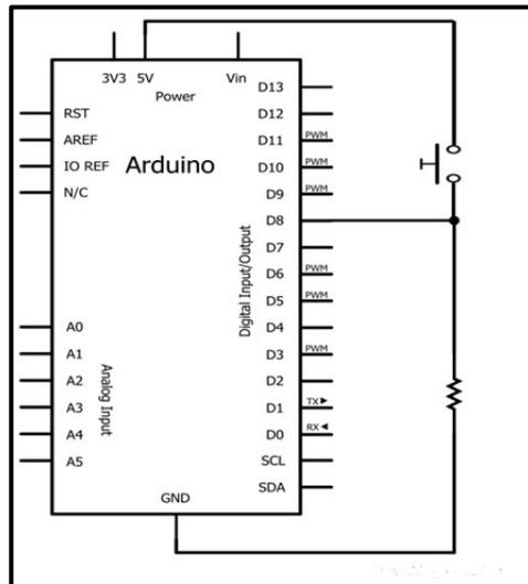
Podemos comprobar cómo las conexiones del pulsador son por un lado directa a la alimentación y por otro a tierra a través de la resistencia “pull-down” (pongamos que de 10 K $\Omega$ ). Existe un tercer cable, conectado entre el pulsador y la resistencia que va a parar a un pin digital de la placa Arduino (en este caso particular, el nº 8). Este pin digital deberá configurarse como pin de entrada porque allí será donde se reciba la señal que indique el estado del pulsador.
