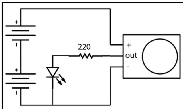
La idea del circuito mostrado es que cuando el sensor PIR (suponiendo el modelo de Adafruit, que no usa resistencia pull-up externa) detecte el movimiento, el pin de datos enviará un pulso HIGH de 3,3 V y por tanto, iluminará el LED. Cuando el LED se apague, se puede probar de pasar la mano por delante, o directamente todo el cuerpo.
