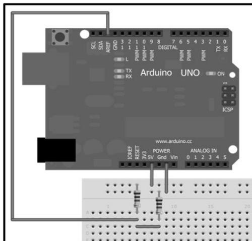
Se deberían usar resistencias de baja tolerancia (1%) para que la señal de referencia sea lo suficientemente precisa. Aunque la manera más exacta de proporcionar una señal rebajada y estable sería usando un regulador de tensión apropiado.
