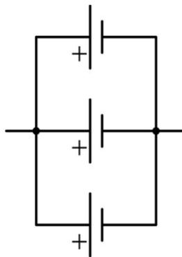
Un conjunto de pilas en paralelo ofrece el mismo voltaje que una sola pila individual (es decir, si tenemos por ejemplo cuatro pilas de 1,5 V conectadas en paralelo, este conjunto dará igualmente un voltaje total de 1,5 V). La ventaja que
