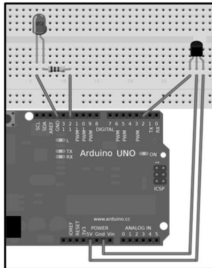
La idea es encender durante unos instantes el LED cuando el sensor IR detecte una señal infrarroja. Pero atención, no vale cualquier señal infrarroja, sino solamente aquella modulada a 38 KHz. Por tanto, para probar este circuito, no podemos usar un LED infrarrojo cualquiera: deberemos usar algún mando de control remoto que tengamos a mano (de un televisor, un reproductor de DVD, un
