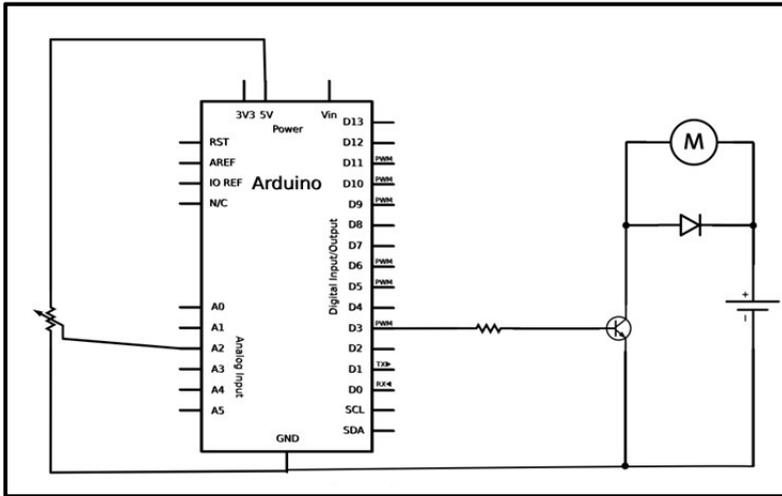
**Ejemplo 6.27:** Para hacer el sketch algo más sofisticado, hemos añadido la condición de que si el valor leído por el potenciómetro no llega a un nivel mínimo (“umbral”), el motor no se pone en marcha; y cuando se pone en marcha, entonces ya sí que su velocidad es proporcional a la lectura recibida del potenciómetro:
