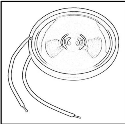
En vez de zumbadores, podemos utilizar altavoces sencillos de poca potencia (0,5 W, por ejemplo), como los productos 9151 o 10722 de Sparkfun. Al igual que los zumbadores, los altavoces generan ondas acústicas a partir de las señales eléctricas que reciben, pero el mecanismo físico para lograrlo es mucho más sofisticado, por lo que podremos lograr una calidad y un volumen de sonido bastante mayor.
