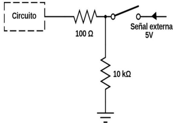
En este ejemplo la resistencia “pull-down” es de 10 KΩ. Cuando el interruptor esté pulsado, la entrada del circuito estará conectada a una señal de entrada válida, como antes. Cuando el interruptor se deja de pulsar, la entrada del circuito estará conectada a la resistencia “pull-down”, la cual tira hacia tierra (que es una referencia siempre fija).
