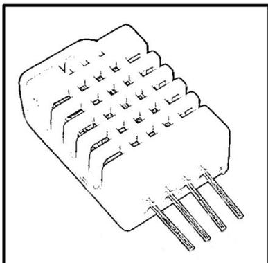
Sus características técnicas más destacables son: se puede alimentar con un voltaje de entre 3 V y 5 V y 2,5 mA como máximo, puede medir un rango de temperaturas entre -40 y 125 °C con una precisión de  $\pm 0,5$  °C y un rango de humedad entre 0 y 100% con una precisión del 2-5%. Está formado básicamente por un sensor de humedad capacitivo y un termistor.
