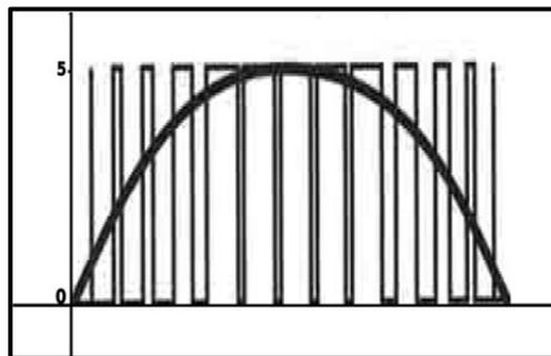
Cada pin-hembra PWM tiene una resolución de 8 bits. Esto quiere decir que si contamos el número de combinaciones de 0s y 1s que se pueden obtener con 8 posiciones, obtendremos un máximo de  $2^8$  (256) valores diferentes posibles. Por
