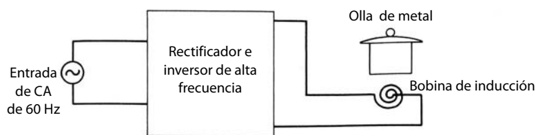
Figura 16-6 Cocido por inducción.
