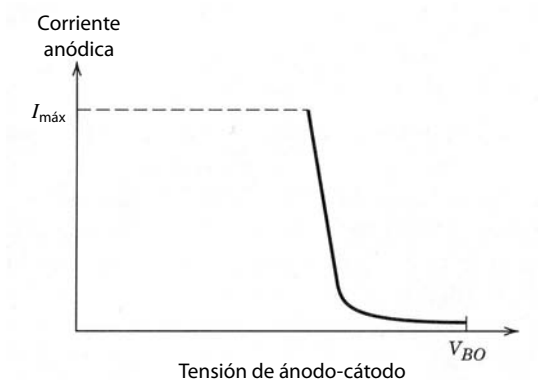
Figura 26-11 Esbozo cualitativo del área de operación segura del MCT.
