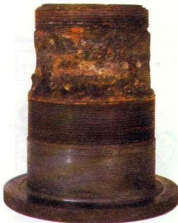
Fig. 13.67. Tobera corroída en una válvula de seguridad.
