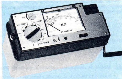
Fig. 5.13. Instrumento para medir aislamientos.
