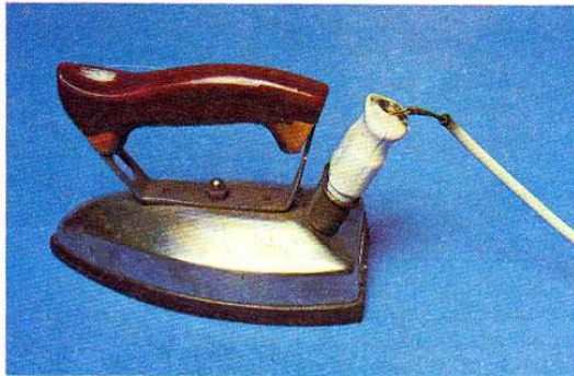
Fig. 14.1. Cable de conexión defectuoso en una plancha eléctrica.
