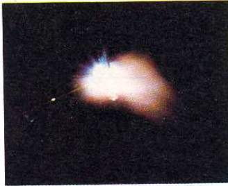
Fig. 14.7. Cortocircuito a 220 V; arco voltaico con partículas de cobre despedidas.
