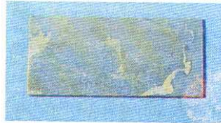
Fig. 13.12. Superficie de una chapa de acero atacada por el ácido clorhídrico.
