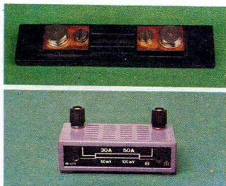
Fig. 4.12. Shunts (resistencias en paralelo).
