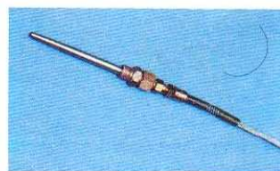
Fig. 1.35. Par termoeléctrico. Unidad Operativa SENATI - Abancay
