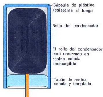
Fig. 11.37. Corte a través de un rollo de condensador con cápsula de plástico.
