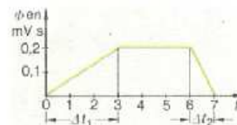
Fig. 12.53. Gráfica de la tensión en una bobina.
