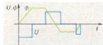
Fig. 12.53. Gráfica de la tensión en una bobina.
