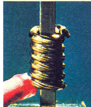
Fig. 15.101. Wire-wrapping (aumentado aprox. 10 veces).
