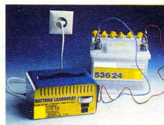
Fig. 13.52. Montaje para la carga de un acumulador.
