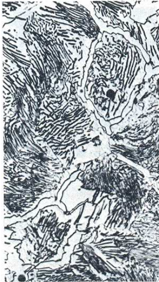
Fig. 15.14. Microfotografía de una estructura con gran contenido de cementita (la cementita es la red blanca entre los límites de los granos).
