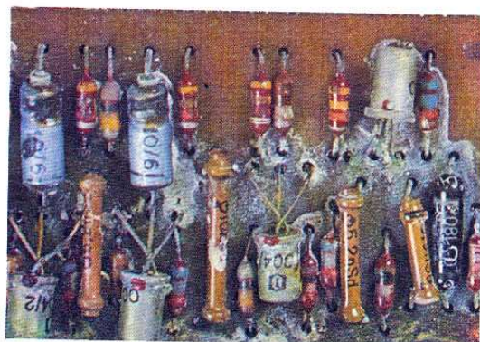
Fig. 13.1. Corrosión debida a un líquido en un circuito electrónico.
