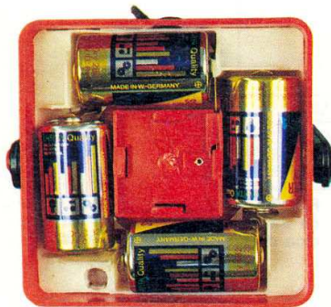
Fig. 8.5. Conexión en serie de cuatro pilas secas en una linterna.
