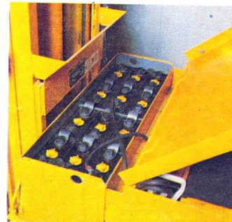
Fig. 13.27. Acumuladores de una carretilla elevadora de horquilla.
