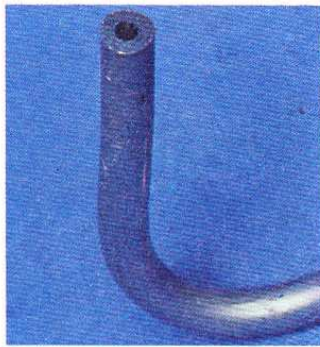
Fig. 15.105. Tubo de soldadura con alma de fundente.
