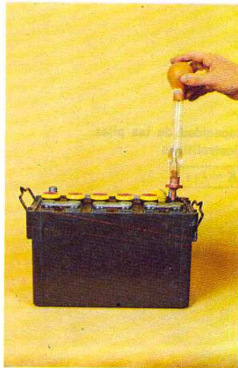
Fig. 13.59. Determinación de la densidad del ácido sulfúrico con un densímetro.
