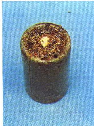
Fig. 13.44. Pila en la que ha habido fugas.
