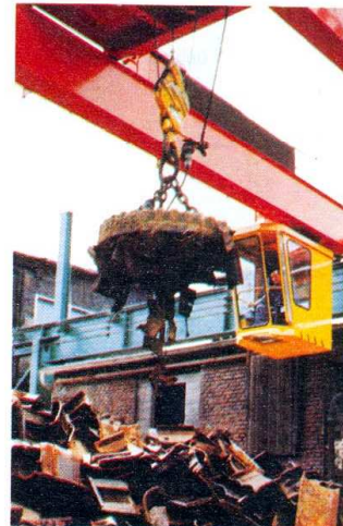
Fig. 1.56. Ejemplo de efecto magnético: electroimán.
