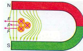
Fig. 12.38. Fuerza sobre tres conductores recorridos por corriente en un campo magnético.
