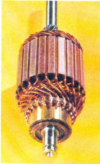
Fig. 15.81. Aislamiento de ranuras en el devanado de un motor (hemos representado una fase intermedia de su fabricación).
