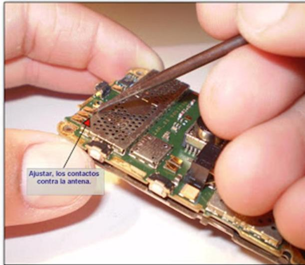
Realizar una verificación de la zona de RF, en especial la zona de Rx, en RF, realizar un repaso de soldadura de todos los cristales y filtros.
