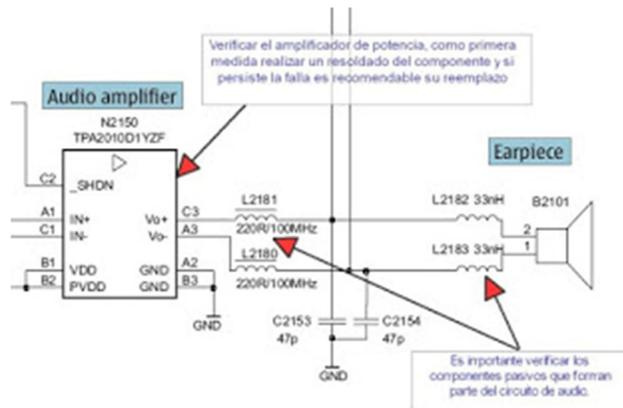
En los esquemáticos encontraremos la lista de componentes y su posición en el mapa de la placa, por ejemplo, para el caso del amplificador de audio, el componente es N2150 y su posición es M7.
