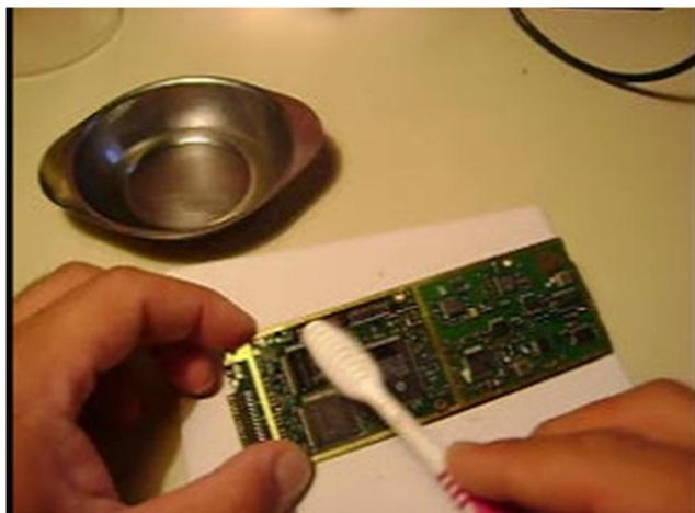
En muchos casos se deberá también realizar un resoldado de componentes con el soldador de aire caliente de las partes más afectadas por el sulfato a modo de garantizar la correcta reparación.
