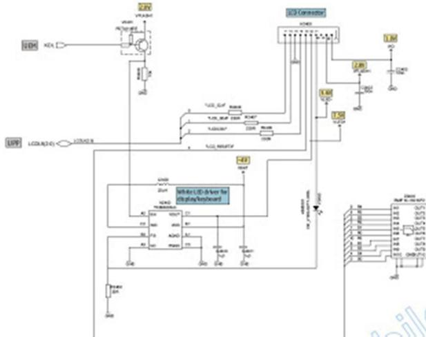
Al seguir las pistas de conector de display, encontramos el controlador del panel de luz, N2400, es un componente BGA.
