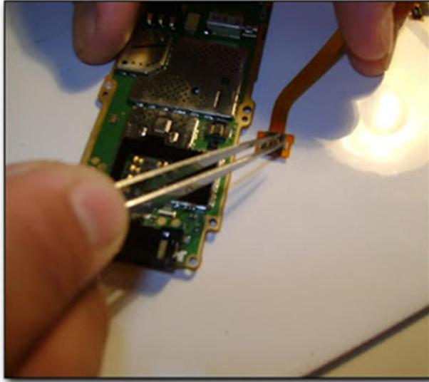
En teléfonos con tapa, ya sea del tipo flip (tapita) o tapa deslizable verificar el conector flexible.
