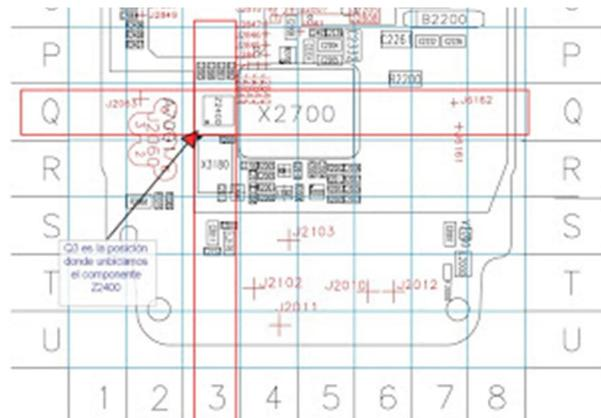
En la sección de la siguiente foto, se puede apreciar el componente Z2400 que lo ubicamos tras el análisis en el manual esquemático.
