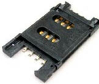
El siguiente paso es verificar el conector de SIM Card, generalmente, a consecuencias de golpes y/o torsión del equipo se pueden generar problemas por falso contacto, por tanto recomendamos una limpieza, ajuste, resoldado y/o reemplazo del conector de SIM Card, dependiendo del estado en que se encuentre.
