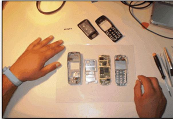
Realizar la limpieza de cada contacto de la placa en la cual esta sea participe de alguna pieza externa a través de simple contacto, es decir, limpiar con un borrador los contactos de cobre en la placa donde se conecta a través de simple contacto, piezas como el auricular, timbre, conector inferior, conector de vibrador, conector de antena, batería, etc.
