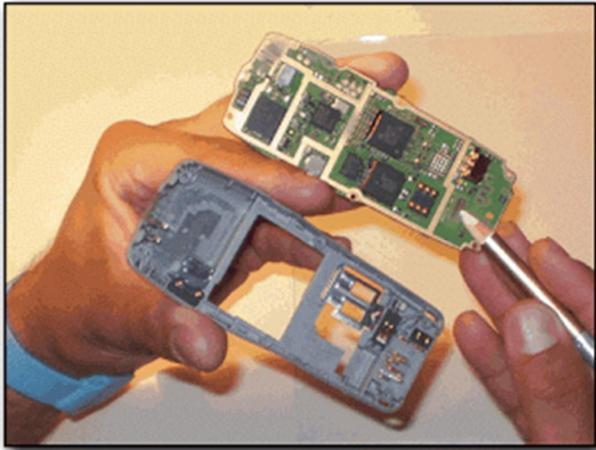
Posteriormente, ensamblar cada pieza en el lugar correcto, ajustar la carcaza y ver de que esta asiente correctamente, si la misma no asienta correctamente es recomendable reemplazar la carcaza, ya que en muchas ocasiones las fallas de falso contacto se producen a consecuencia de una carcaza dañada, que con el tiempo puede repercutir en fallas muchos más severas.
