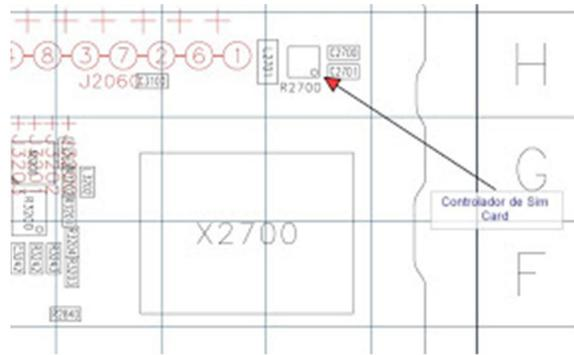
En la sección de la placa se observa el controlador.
