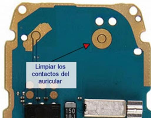
Además, prestar mucha atención! al estado de la carcasa del equipo, debe calzar correctamente con la placa, y debe ajustarse correctamente, en muchas ocasiones, el daño de la carcasa al no ajustarse correctamente, genera un falso contacto entre los contactos de la placa y el auricular, lo que repercute en una falla de audio.
