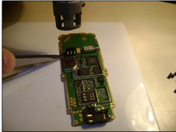
Después, verificar switch de encendido (tecla power)
