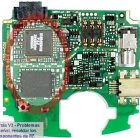
Motorola V3 - Problemas de señal, resoldar los componentes de RF.
