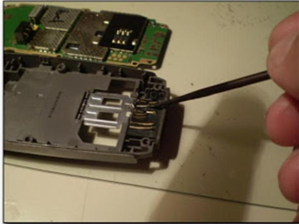
Siguiente, verificar el conector de batería.
