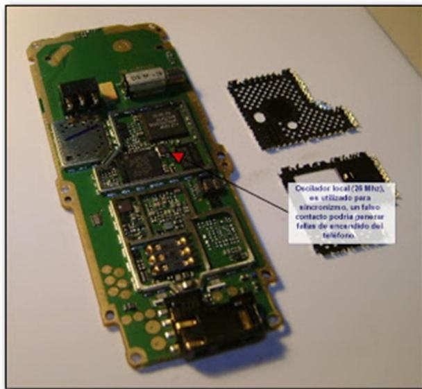
Verificar el P.A. (amplificador de potencia) en RF, ya que en ocasiones cuando el P.A. se encuentra en corto, presenta un alto consumo que no es soportado por la batería y ocasiona un problema de encendido.
