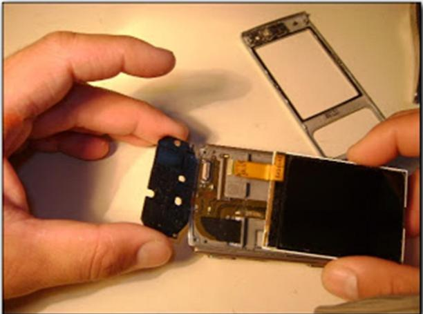
Si al desarmar el teléfono, encontramos que posee dos, placas, por ejemplo, la placa principal y el display se encuentra en la placa secundaria, deberán verificar el conector de entre placas, y realizar una limpieza, ajuste, resoldado y/o reemplazo del conector.
