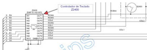
Al final del manual esquemático podrán encontrar la lista de componentes y la posición en el mapa de placa, para el caso del controlador del teclado Z2400, le corresponde la posición Q3
