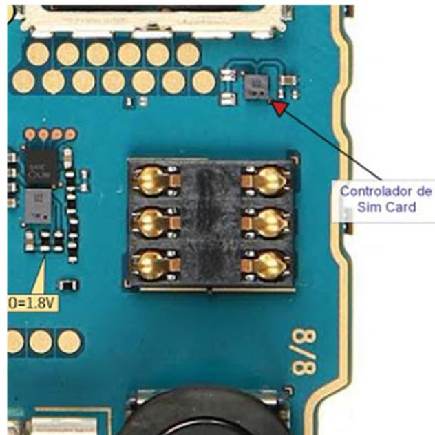
Posterior al análisis, resta reemplazar el componente, utilizando el soldador de aire caliente y pasta o flux para soldar. El procedimiento indicado lo pueden realizar en cualquier marca/modelo de teléfono celular, el análisis no cambia, siempre es el mismo, lo importante es tener el manual esquemático de la marca/modelo a reparar.
