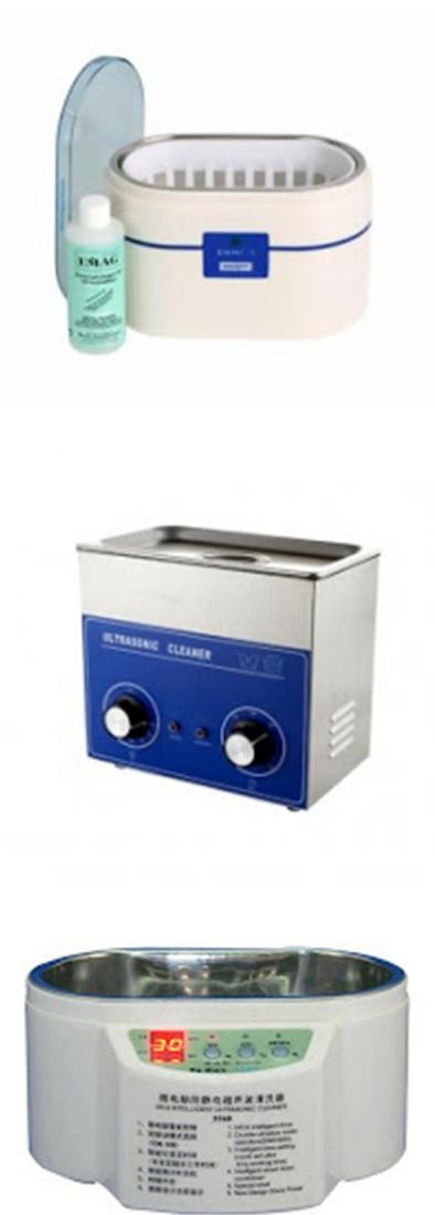
Otra herramienta muy importante para realizar desulfataciones de placas son los limpiadores ultrasónicos, estos equipos tienen una especie de recipiente donde deberán colocar alcohol isopropílico de tal manera a cubrir la placa, después se debe setear el tiempo que podría variar de 1 a 3 minutos, enciende el limpiador y una vez terminado el proceso de limpieza, retiraran la placa y la secan utilizando un soldador de aire caliente.
