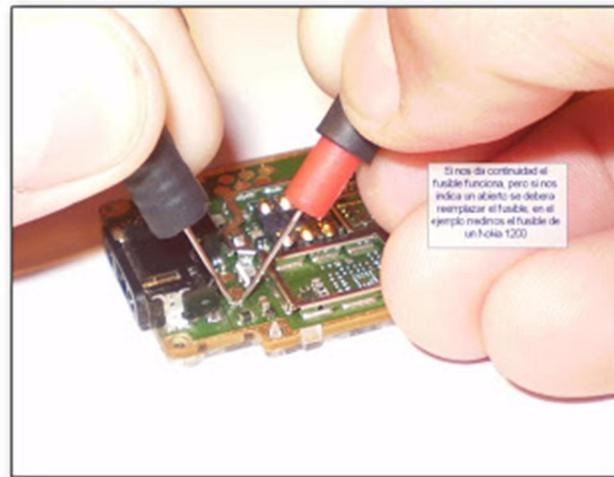
La pregunta sería, ¿Cómo se cual es el fusible de carga de un teléfono?, para ello deberán contar con el manual esquemático del teléfono y verificar el circuito de carga, generalmente el componente lo indican con el prefijo F, por ejemplo F2000., en el siguiente ejemplo vemos el circuito de carga correspondiente al Nokia 5200.
