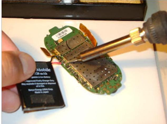
En caso de equipos de dos placas, limpiar y/o resoldar el conector de entre placas, estos pueden provocar que se apague un equipo.
