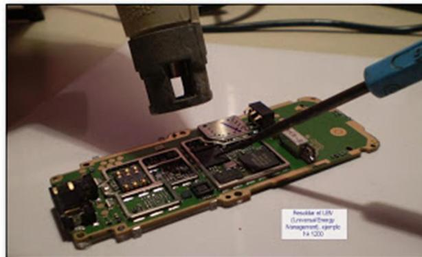
Esto implica resoldar con el soldador de aire caliente los circuitos integrados que conforman el área lógica, ya que una de las funciones de estos IC es de distribuir la corriente adecuada a cada punto de la placa, un desperfecto o falso contacto en este tipo de componente podría implicar un problema de carga en el teléfono.
