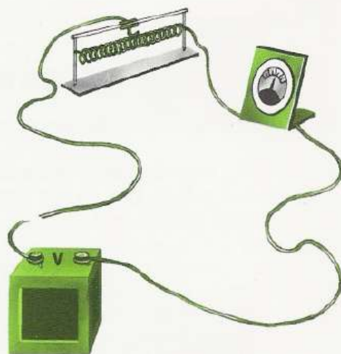
Variando la posición del cursor de la resistencia, se pueden obtener corrientes variables.
