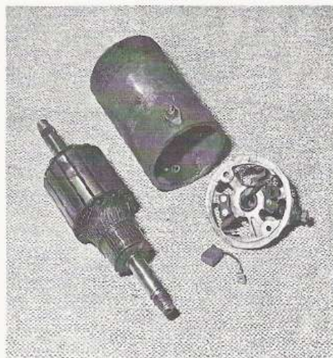
Generador de corriente desmontado. A la izquierda se encuentra el rotor. Se pueden apreciar sus bobinas introducidas en las hendiduras del cilindro central.
