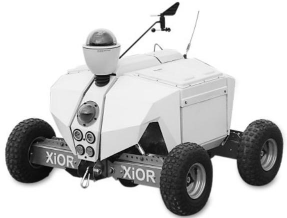
**Figura 13.** *Sphinx, otro modelo de XiOR para el control de pozos de petróleo.*
