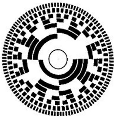
**Figura 9.** Rueda de posicionamiento absoluta con sensores infrarrojos.
