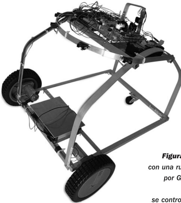
**Figura 11.** Robot diferencial con una rueda libre, desarrollado por Garnet Hertz. Es la base de un robot que luego se controló ¡con una cucaracha!
