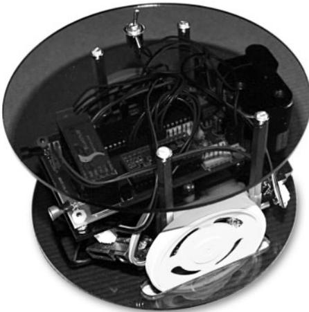
**Figura 16.** Robot con piezas de acrílico.
