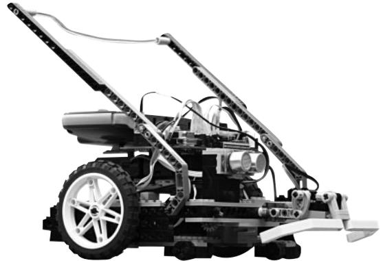
**Figura 13.** Aquí podemos ver un robot hecho con piezas de Lego, pero con sensores y controlador propios.
