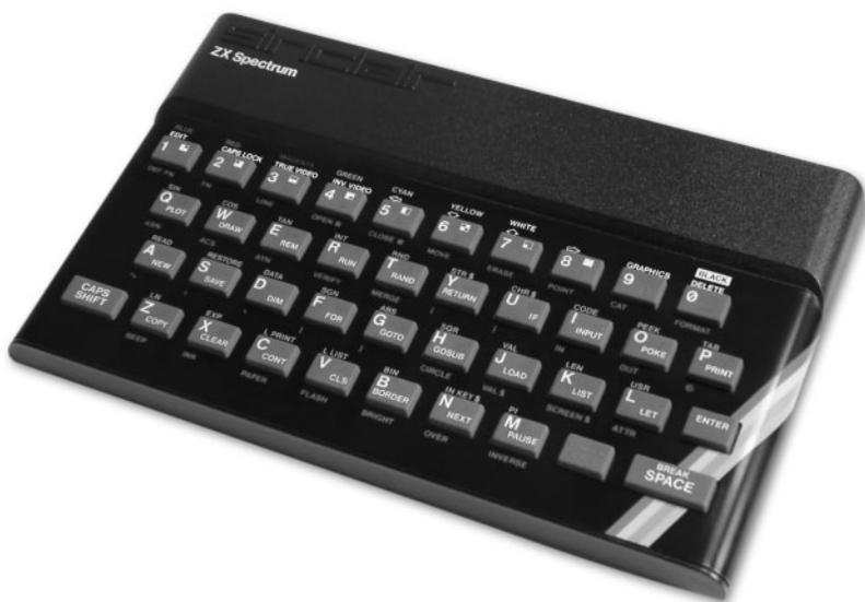
**Figura 1.** Una *Sinclair Spectrum* que, con 48 Kb de RAM, desafiaba nuestra capacidad de programar con poca memoria y baja velocidad.
