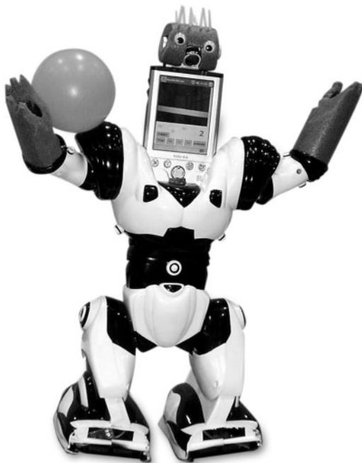
**Figura 17.** Robot Robosapien hackeado con una PDA en su cabeza como procesador.
