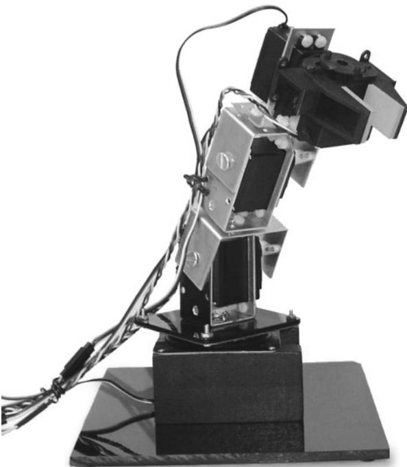
**Figura 5.** Kit de brazo robótico RA-01 con 5 servos.
