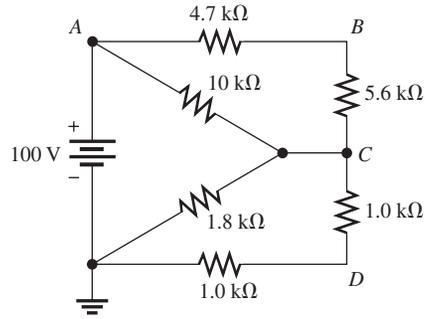
14. Determine la resistencia entre A y B en la figura 7-67 sin la fuente.
