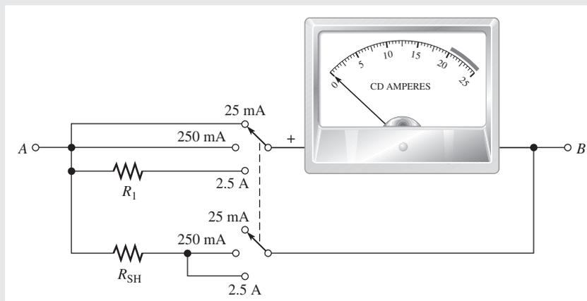
Para el intervalo de 2.5 A, la corriente que circula por el movimiento de medidor con deflexión de escala completa sigue siendo de 25 mA. Esta es también la corriente que pasa por  $R_1$ .
