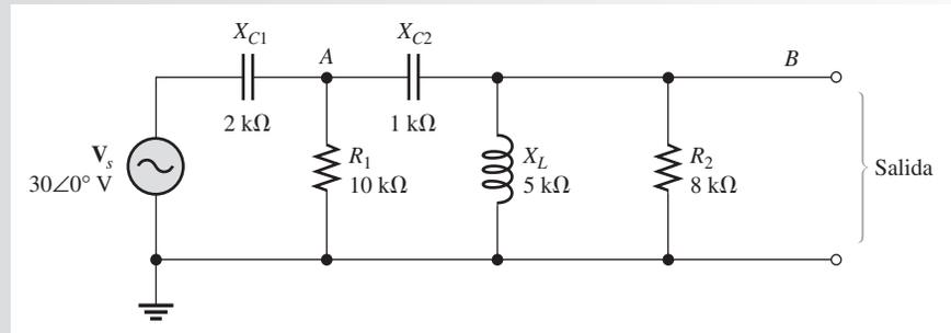
**Solución** El voltaje ( $V_B$ ) en el punto *B* es el voltaje entre las terminales de salida abiertas. Use el método del divisor de voltaje. Para ello, primero debe conocer el voltaje ( $V_A$ ) en el punto *A*; por lo que es necesario determinar la impedancia desde el punto *A* hasta tierra como un punto de partida.
