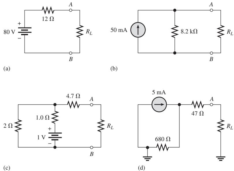
31. En el circuito de la figura 8-86, determine el valor de  $R_L$  para transferencia de potencia máxima.
