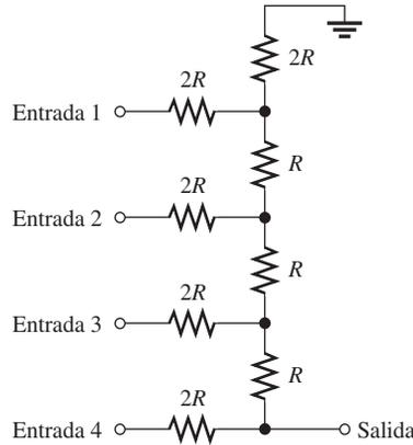
A continuación examinamos la operación general de un red  $R/2R$  en escalera utilizando el circuito de cuatro escalones mostrado en la figura 7-43. En un curso posterior de fundamentos digitales, se aprenderá específicamente cómo se utiliza este tipo de circuito en la conversión D/A.
