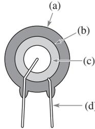
18. Identifique las partes del capacitor de disco de cerámica mostrado en la vista de corte de la figura 12-67.
