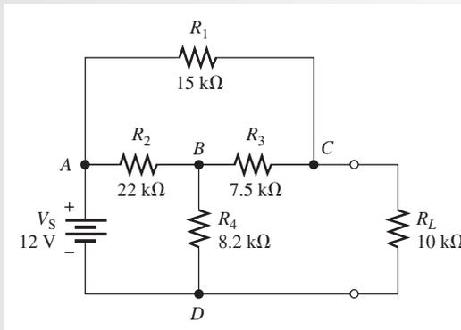
**Solución** (a) Aplique la ley de la corriente de Kirchhoff en los nodos *B* y *C* en función de voltajes de nodo. Para mantener los coeficientes más manejables, todas las resistencias se muestran en kΩ. La corriente estará en mA.
