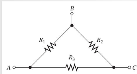
**Solución** 1. De A a B:  $R_1$  está en paralelo con la combinación en serie de  $R_2$  y  $R_3$ .
