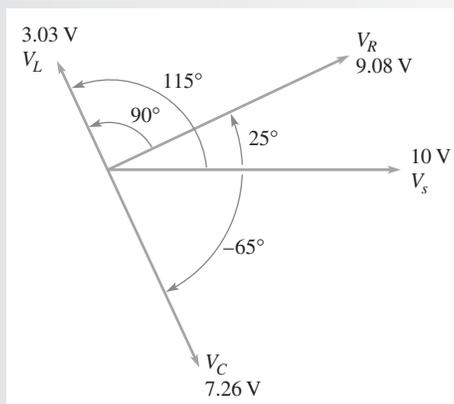
recería con el mismo ángulo que  $V_R$ . La corriente adelanta en  $25^\circ$  a  $V_s$ , que es el voltaje de fuente, lo cual indica la presencia de un circuito capacitivo ( $X_C > X_L$ ). El diagrama fasorial gira  $25^\circ$  a partir de su posición usual porque la referencia es el voltaje de fuente,  $V_s$ , el cual se muestra orientado a lo largo del eje  $x$ .
