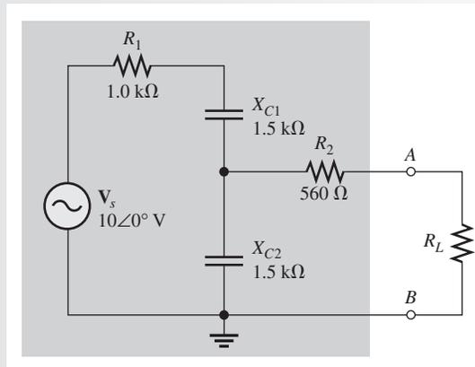
**Solución** Para este circuito, el voltaje de Thevenin entre las terminales *A* y *B* es el voltaje que aparece entre *A* y *B* con  $R_L$  retirado del circuito.
