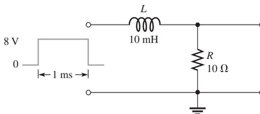
19. Trace el voltaje de salida del integrador en la figura 20-67, muestre voltajes máximos.
