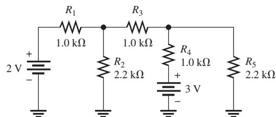
9. Con el teorema de superposición, determine la corriente a través de  $R_3$  en la figura 8-70.
