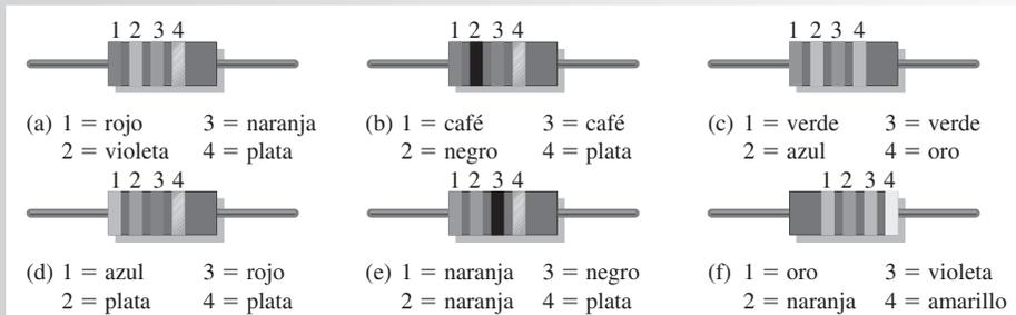
4. De entre los resistores mostrados en la figura 2-38, elija los siguientes valores: 330 Ω, 2.2 kΩ, 56 kΩ, 100 kΩ, y 39 kΩ.
