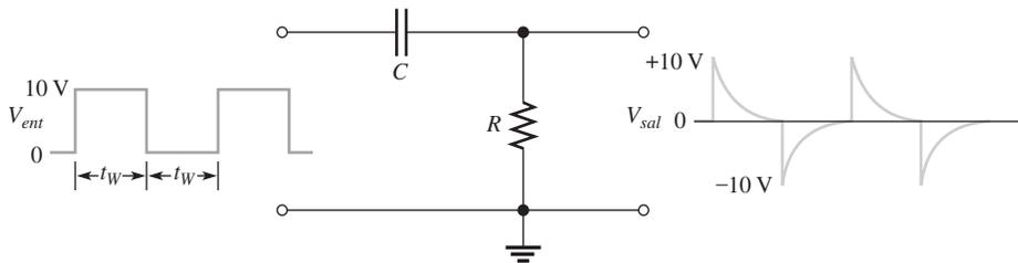
La figura 20-29 muestra la salida en estado permanente cuando  $t_W < 5\tau$ . Conforme la constante de tiempo se incrementa, las partes inclinadas positiva y negativamente se aplanan. Para una constante de tiempo muy larga, la salida se aproxima a la forma de la entrada, pero con un valor promedio de cero.
