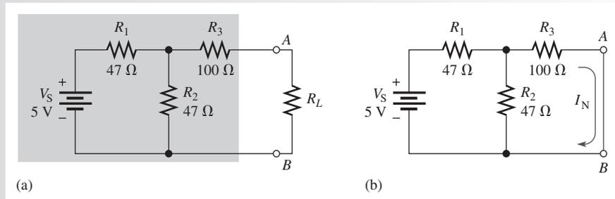
**Solución** Ponga en cortocircuito las terminales A y B como se muestra en la figura 8-48(b).  $I_N$  es la corriente que circula a través del cortocircuito. En primer lugar, la resistencia total vista por la fuente de voltaje es
