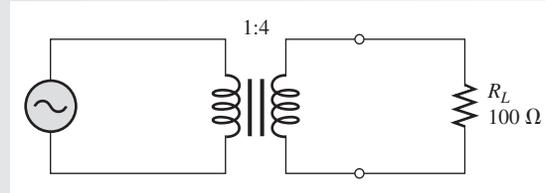
**Solución** La resistencia reflejada se determina con la ecuación 14-8.
