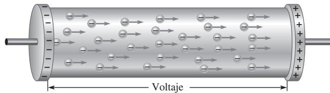
El movimiento de estos electrones libres del extremo negativo del material al extremo positivo es la corriente eléctrica, simbolizada mediante  $I$ .
