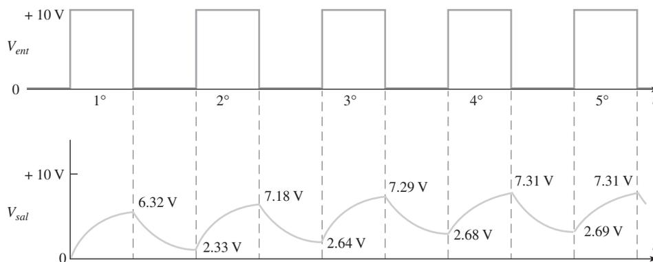
**Primer pulso** Durante el primer pulso, el capacitor se carga. El voltaje de salida llega a 6.32 V (63.2% de 10 V), como indica la figura 20-15.
