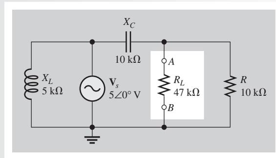
**Solución** Con la fuente de voltaje reemplazada por su impedancia interna (cero en este caso),  $X_L$  queda efectivamente fuera del circuito.  $R$  y  $C$  aparecen en paralelo vistas desde las terminales abiertas, como se indica en la figura 19-23.  $Z_{th}$  se calcula como sigue:
