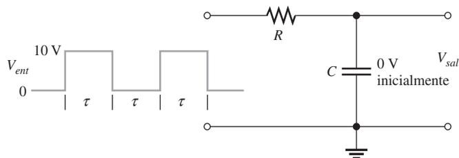
Suponga que el capacitor de la figura 20-14 inicialmente comienza a descargarse y examine el voltaje de salida pulso a pulso. La figura 20-15 muestra las formas de carga y descarga de cinco pulsos.
