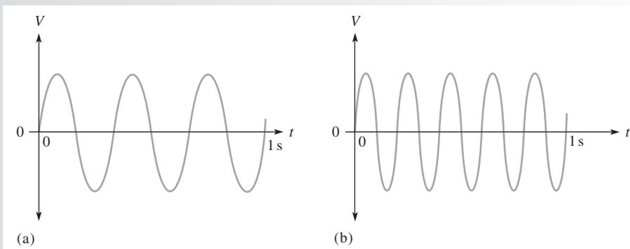
**Solución** La onda seno de la figura 11-9(b) tiene la frecuencia más alta porque completa más ciclos en 1 s que la onda seno de la parte (a).
