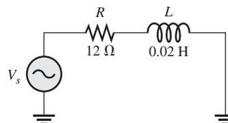
6. Determine los valores de  $R$  y  $X_L$  en un circuito RL en serie con los siguientes valores de impedancia total:
