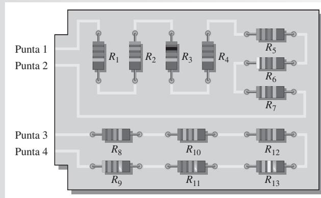
**Solución** Los resistores  $R_1$  a  $R_7$  están conectados en serie uno al otro. Esta combinación en serie está conectada entre las puntas 1 y 2 del circuito impreso.
