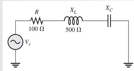
**Solución**  $X_L = X_C$  en frecuencia resonante. Por tanto,  $X_C = X_L = 500 \Omega$ . En condición resonante la impedancia es
