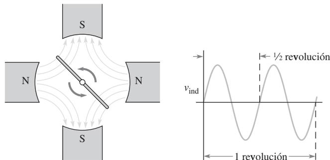
▲ FIGURA 11-13 Cuatro polos logran una frecuencia más alta que dos con las mismas rps.
