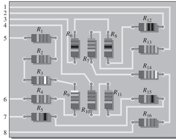
3. Determine la resistencia nominal presente entre las puntas 1 y 8 del circuito de la figura 5-68.
