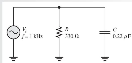
**Solución** En la figura 15-40,  $R = 330 \Omega$ ; por tanto,  $G = 1/R = 1/330 \Omega = 3.03 \text{ mS}$ . La reactancia capacitiva es
