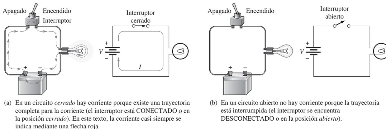
(a) En un circuito *cerrado* hay corriente porque existe una trayectoria completa para la corriente (el interruptor está CONECTADO o en la posición *cerrado*). En este texto, la corriente casi siempre se indica mediante una flecha roja.
