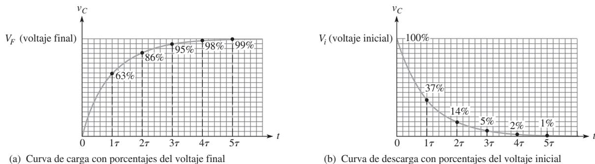
▲ FIGURA 12-31 Curvas de voltaje exponenciales correspondientes a la carga y descarga de un circuito RC.
