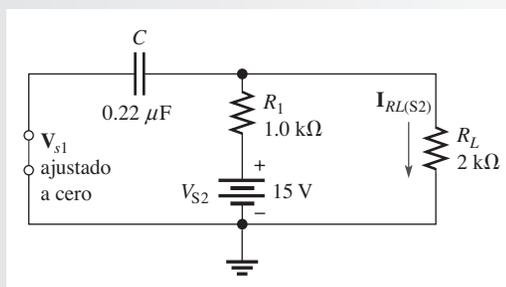
**Paso 3.** Por superposición, la corriente total en  $R_L$  es de  $1.69 \angle 47.3^\circ$  mA montada sobre un nivel de cd de 5 mA, como se indica en la figura 19-10.
