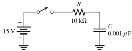
33. En la figura 12-75, el capacitor se carga a 25 V. Cuando se cierra el interruptor, ¿cuál es el voltaje presente en el capacitor en los instantes posteriores?
