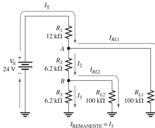
a través de  $R_{RL2}$  y en  $I_3$  a través de  $R_3$ . A  $I_3$  se le llama **corriente remanente**, y es la corriente que queda después de restar la corriente de carga total del total de corriente presente en el circuito.
