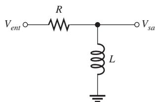
el voltaje de salida aumenta hasta que es igual a  $V_{ent}$ . La expresión para la frecuencia crítica de un filtro pasaaltas es la misma que para el filtro pasabajas.
