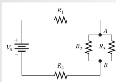
**Solución** Se empieza en la terminal positiva de la fuente, siguiendo las trayectorias de corriente. Toda la corriente producida por la fuente debe irse a través de  $R_1$ , que está en serie con el resto del circuito.
