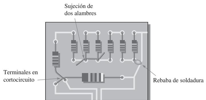
Cuando existe un **corto**, una parte de la resistencia en serie es evitada (toda la corriente pasa por el corto), con lo que se reduce la resistencia total como se ilustra en la figura 5-63. Advierta que la corriente se incrementa a consecuencia del corto.
