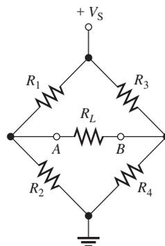
Con el teorema de Thevenin, se puede simplificar el circuito puente a un circuito equivalente visto desde el resistor de carga según muestra paso a paso la figura 8-39. Estudie con cuidado los pasos presentados en esta figura. Una vez que se encuentra el circuito equivalente, el voltaje y la corriente para cualquier valor del resistor de carga son fáciles de determinar.
