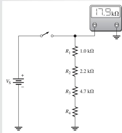
**Solución** Por la lectura del ohmmetro,  $R_T = 17.9 \text{ k}\Omega$ .
