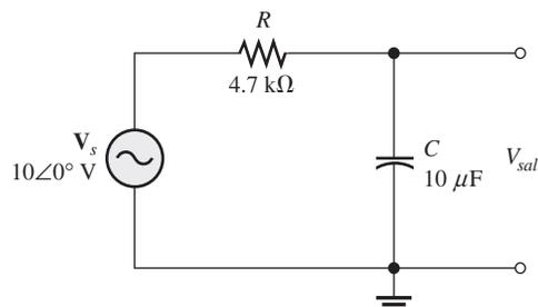
\*66. Los capacitores de la figura 15-107 han desarrollado un resistencia de fuga de  $2\text{ k}\Omega$ . Determine los voltajes de salida en esta condición para cada circuito.
