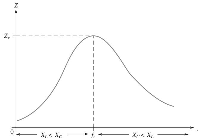
A frecuencias muy bajas,  $X_L$  es muy pequeña y  $X_C$  muy alta, así que la impedancia total es igual a la de la rama inductiva. Conforme aumenta la frecuencia, la impedancia también se incrementa y la reactancia inductiva domina (porque es menor que  $X_C$ ) hasta que se alcanza la frecuencia resonante. En este momento, desde luego,  $X_L > X_C$  (con  $Q > 10$ ) y la impedancia llega a su
