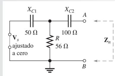
Al ver entre las terminales A y B,  $C_2$  está en serie con la combinación en paralelo de  $R$  y  $C_1$ . Por tanto,
