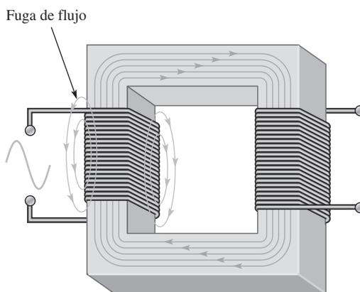
El porcentaje de flujo magnético que llega en realidad al devanado secundario determina el coeficiente de acoplamiento del transformador. Por ejemplo, si nueve de cada diez líneas de flujo permanecen dentro del núcleo, el coeficiente de acoplamiento es de 0.90, o del 90%. La mayoría de los transformadores de núcleo de hierro tiene coeficientes de acoplamiento muy altos (mayores a 0.99), en tanto que los de núcleo de ferrita y núcleo de aire tienen valores más bajos.
