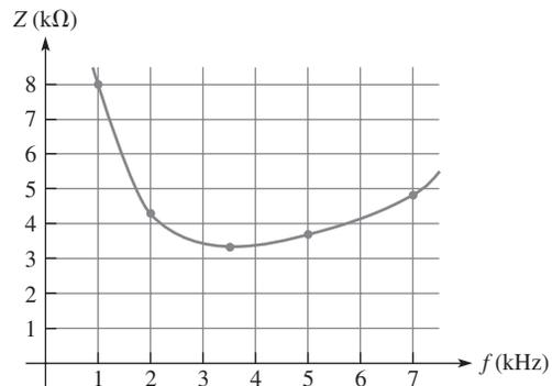
17-3 La corriente se incrementará con la frecuencia hasta cierto punto, y luego disminuirá.
