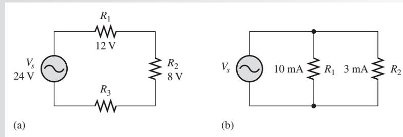
**Solución** (a) Use la ley del voltaje de Kirchhoff para determinar  $V_3$ .
