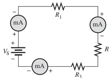
8. Muestre cómo conectar una fuente de voltaje y un amperímetro a la tarjeta de circuito impreso ilustrada en la figura 5-68 para medir la corriente en  $R_1$ . ¿Qué otras corrientes de resistor se miden con esta configuración?
