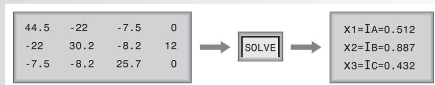
La corriente en  $R_2$  es la diferencia entre  $I_A$  e  $I_B$ .
