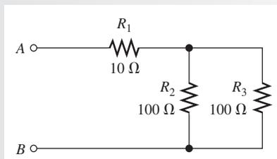
**Solución** En primer lugar, calcule la resistencia en paralelo equivalente de  $R_2$  y  $R_3$ . Como  $R_2$  y  $R_3$  son de igual valor, se utiliza la ecuación 6-4.
