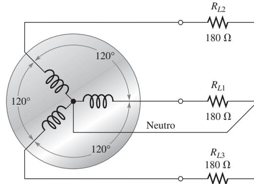
El voltaje entre las terminales de  $R_{L1}$  es de  $120 \angle 0^\circ \text{ V}$ , en  $R_{L2}$  es de  $120 \angle 120^\circ \text{ V}$ , y en  $R_{L3}$  es de  $120 \angle -120^\circ \text{ V}$ , como indica la figura 21-7(a). La corriente suministrada por cada devanado a su respectiva carga es como sigue:
