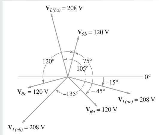
**Problema relacionado** Determine la magnitud del voltaje de línea si la posición del generador indicada en la figura 21-16 gira otros  $45^\circ$  en el sentido de las manecillas del reloj.
