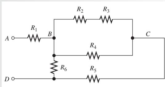
**Solución** Entre los nodos B y C, existen dos trayectorias en paralelo. La trayectoria inferior se compone de  $R_4$ , y la superior de una combinación en serie de  $R_2$  y  $R_3$ . Esta combinación en paralelo está en serie con  $R_5$ . La combinación  $R_2, R_3, R_4, R_5$  está en paralelo con  $R_6$ . El resistor  $R_1$  está en serie con toda esta combinación como lo establece la siguiente expresión:
