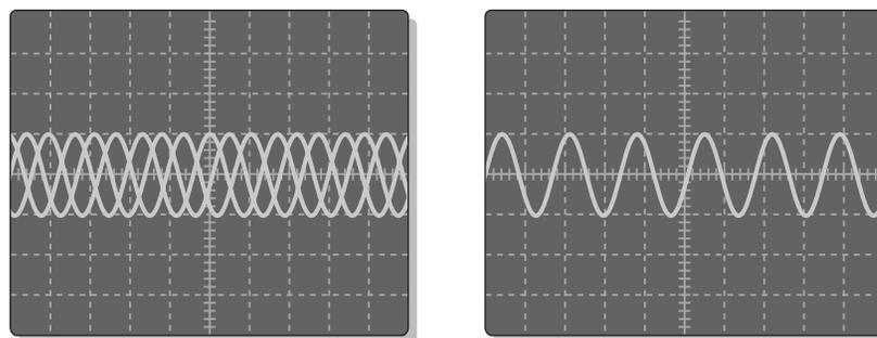
(a) Imagen de forma de onda no disparada (b) Imagen de forma de onda disparada
