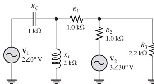
3. Con el teorema de superposición, calcule la corriente a través de  $R_1$  en la figura 19-45.
