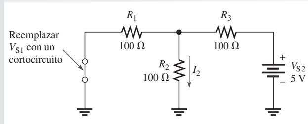
**Paso 3:** Ambos componentes de corrientes descienden por  $R_2$ , de modo que tienen el mismo signo algebraico. Por consiguiente, sume los valores para obtener la corriente total a través de  $R_2$ .
