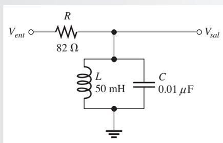
**Solución** Del capítulo 17 (Ec. 17-13), recuerde que la frecuencia resonante (central) de un circuito tanque no ideal es
