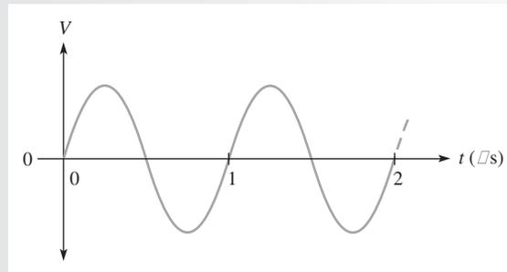
**Solución Método 1:** El periodo se mide a partir de un cruce por cero al cruce por cero correspondiente en el siguiente ciclo (la pendiente debe ser la misma en los cruces por cero correspondientes).
