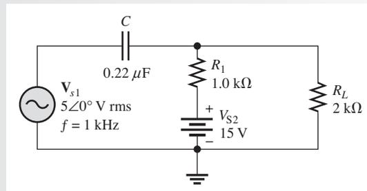
**Solución Paso 1.** Determine la corriente a través de  $R_L$  producida por la fuente de ca  $V_{s1}$  ajustando a cero (reemplazándola con su impedancia interna) la fuente de cd  $V_{s2}$ , como se muestra en la figura 19-8. Desde la perspectiva de  $V_{s1}$ , la impedancia es
