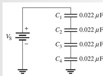
**Solución** Como  $C_1 = C_2 = C_3 = C_4 = C$ , use la ecuación 12-11,
