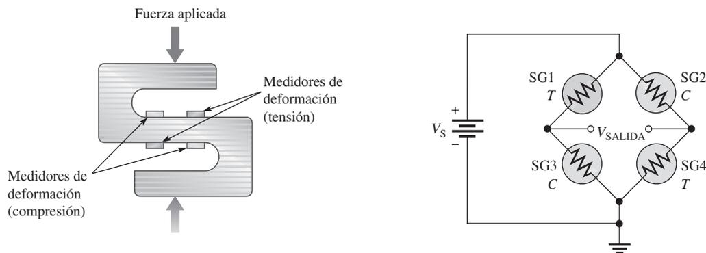
(a) Celda de carga típica con cuatro medidores de deformación activos (b) Puente Wheatstone
