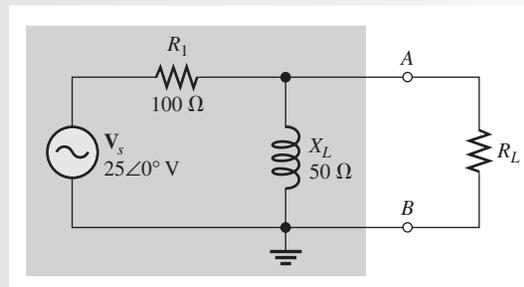
**Solución** Primero, reemplace  $V_s$  con su impedancia interna (cero en este caso), según muestra la figura 19-19. Al examinar entre las terminales A y B, se advierte que  $R_1$  y  $X_L$  están en paralelo. Por tanto,
