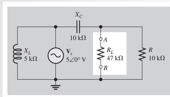
**Solución** Primero retire  $R_L$  y determine el voltaje entre las terminales abiertas resultantes, el cual es  $V_{th}$ . Determine  $V_{th}$  aplicando la fórmula del divisor de voltaje a  $X_C$  y  $R$ .
