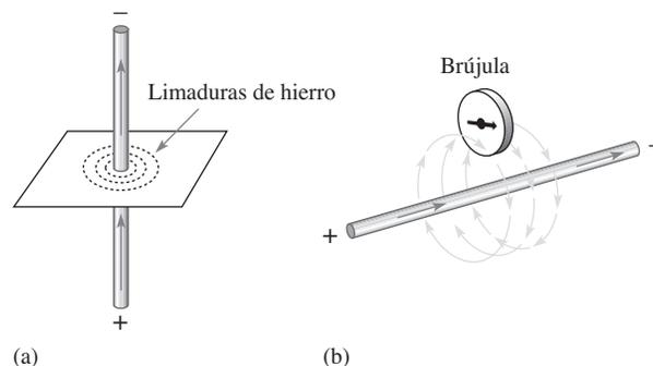
**Regla de la mano derecha** En la figura 10-10 se ilustra una ayuda para recordar la dirección de las líneas de fuerza. Imagine que usted está sujetando el conductor con su mano derecha, con
