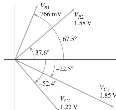
15-22  $V_{R1} = 766 \angle 67.5^\circ \text{ mV}$ ;  $V_{C1} = 1.85 \angle -22.5^\circ \text{ V}$ ;  $V_{R2} = 1.58 \angle 37.6^\circ \text{ V}$ ;
