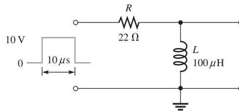
22. Trace la forma de onda de salida si al circuito de la figura 20-69 se le aplica una forma de onda pulsante periódica con  $t_W = 25 \mu s$  y  $T = 60 \mu s$ .
