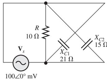
46. Repita el problema 45 con  $R = 5.6 \text{ k}\Omega$ ,  $C_1 = 0.047 \text{ }\mu\text{F}$ ,  $C_2 = 0.022 \text{ }\mu\text{F}$ , y  $f = 500 \text{ Hz}$ .
