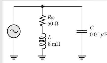
**Solución** Antes de poder calcular la impedancia con la ecuación 17-16, debe determinar el factor de calidad. Para obtener  $Q$ , encuentre primero la reactancia inductiva.
