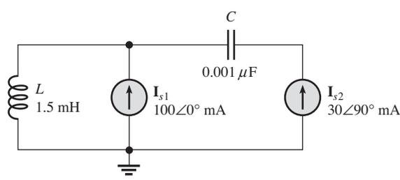
**Solución Paso 1.** Determine la corriente que circula por el inductor producida por la fuente de corriente  $I_{s1}$  reemplazando la fuente  $I_{s2}$  con una abertura, según muestra la figura 19-5. Como puede advertir, los 100 mA producidos por la fuente de corriente  $I_{s1}$  pasan a través del inductor.
