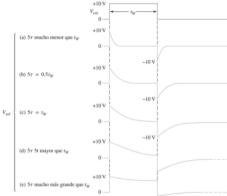
▲ FIGURA 20-23 Efectos de un cambio de constante en la forma del voltaje de salida de un diferenciador RC.
