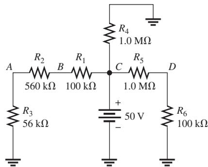
18. Determine la resistencia del circuito mostrado en la figura 7-67 como se ve desde la fuente de voltaje.
