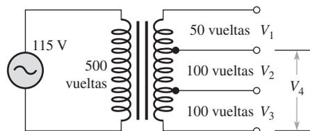
28. Con los voltajes indicados en la figura 14-52, determine la relación de vueltas de cada sección de toma del devanado secundario al devanado primario.
