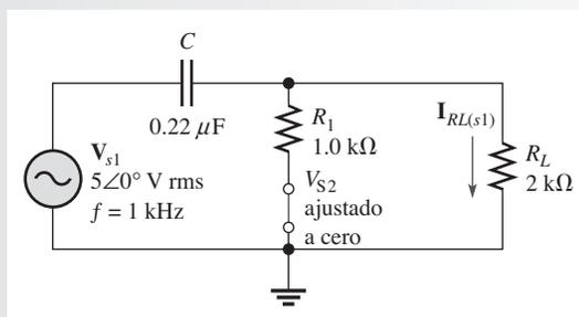
**Paso 2.** Determine la corriente en  $R_L$  producida por la fuente  $V_{s2}$  ajustando a cero  $V_{s1}$  (reemplazándola con su impedancia interna), como se muestra en la figura 19-9. La magnitud de la impedancia vista por  $V_{s2}$  es
