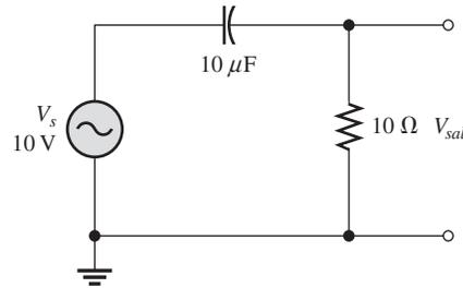
37. Trace la curva de respuesta a la frecuencia de amplitud de salida para el circuito de adelanto de la figura 15-92 con un intervalo de frecuencia de 0 Hz a 10 kHz en incrementos de 1 kHz.
