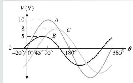
**Solución** La onda seno  $A$  es la referencia. La onda seno  $B$  se desplaza hacia la izquierda  $20^\circ$  con respecto a  $A$ , de modo que se adelanta. La onda seno  $C$  se desplaza hacia la derecha  $45^\circ$  con respecto a  $A$ , así que se retrasa.
