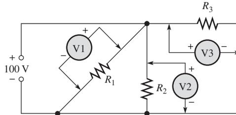
6. ¿Cuál es la resistencia total del circuito visto desde la fuente de voltaje para cada posición del interruptor incluido en la figura 6-68?
