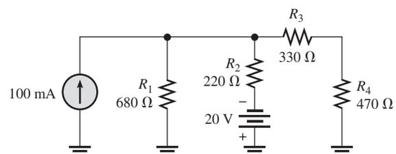
10. Con el teorema de superposición, determine la corriente de carga en cada uno de los circuitos mostrados en la figura 8-71.
