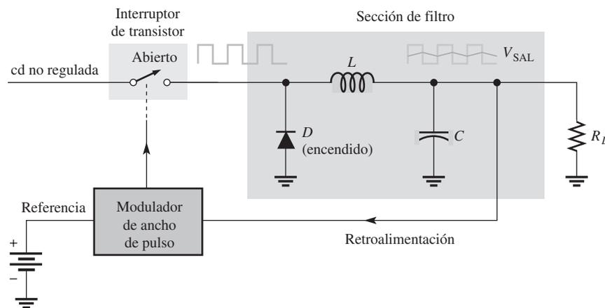
La figura 16-43 ilustra la acción filtrante básica. El filtro se compone de un diodo, un inductor y un capacitor. El diodo es un dispositivo para corriente de un solo sentido que se estudiará en un curso de dispositivos. En esta aplicación, el diodo actúa como un interruptor de encendido-apagado que permite fluir a la corriente en una sola dirección.
