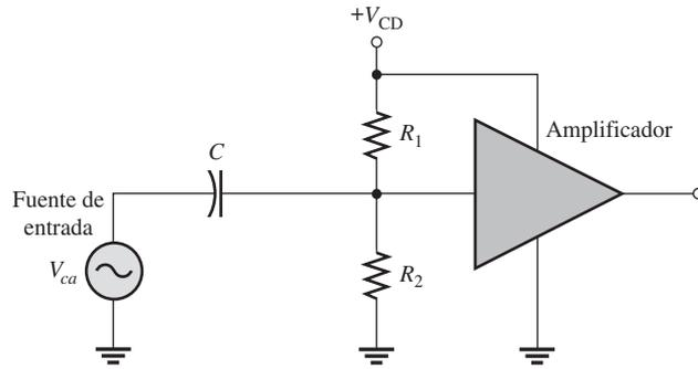
que la señal de voltaje a ser amplificada se acople mediante un capacitor y se superponga sobre el nivel de cd. El capacitor impide que la baja resistencia interna de la fuente de señal afecte el voltaje de polarización de cd.
