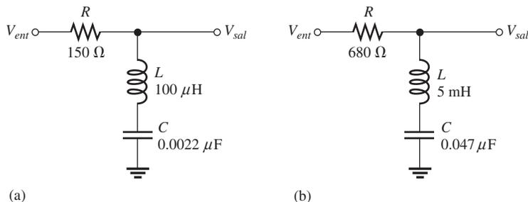
25. Para cada filtro de la figura 18-47, determine la frecuencia central de la banda de rechazo.
