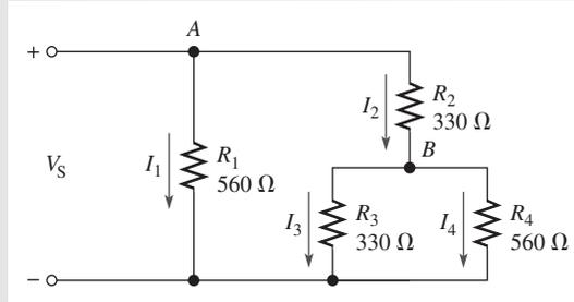
**Solución** Primero, determine la corriente ( $I_2$ ) hacia el nodo  $B$ . Una vez que conozca esta corriente, use la fórmula del divisor de corriente para encontrar  $I_4$ , la corriente a través de  $R_4$ .
