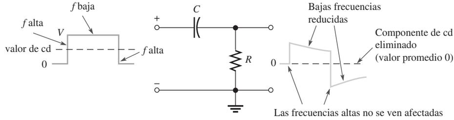
salida, se desarrolla menos voltaje en  $L$  a frecuencias bajas que a frecuencias altas. Hay cero volts a la salida para cd (omitiendo la resistencia de devanado). Para frecuencias altas, la mayor parte del voltaje de entrada disminuye entre las terminales de la bobina de salida ( $X_L = 0$  para cd;  $X_L \cong$  circuito abierto para frecuencias altas). La figura 20-51 muestra la acción de filtro pasaaltas.
