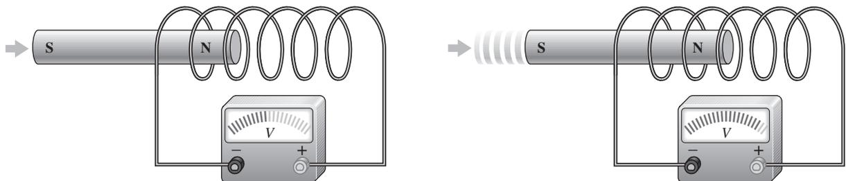
(a) Conforme el imán se mueve lentamente hacia la derecha, su campo magnético cambia con respecto a la bobina, y se induce un voltaje
