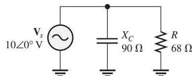
44. Para el circuito en paralelo de la figura 15-96, encuentre la magnitud de cada corriente de rama y la corriente total. ¿Cuál es el ángulo de fase entre el voltaje aplicado y la corriente total?
