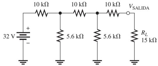
\*18. Con el teorema de Thevenin, determine el voltaje entre los extremos de  $R_4$  en la figura 8-78.
