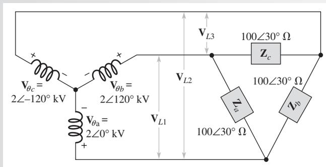
**Solución** Con  $V_L = \sqrt{3}V_\theta$  (ecuación 21-2) y el hecho de que hay  $30^\circ$  entre cada voltaje de línea y el voltaje de fase más cercano, los voltajes de carga son
