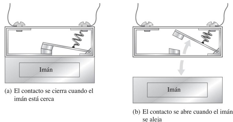
como indica la figura 10-6(a), el brazo metálico se mantiene en su posición NC. Cuando el imán se aleja, el resorte jala el brazo hacia arriba, lo cual rompe el contacto, según muestra la parte (b).
