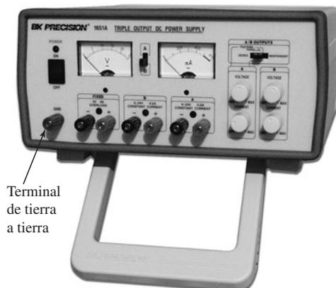
lida. Cada una de las fuentes de potencia presentes en el mismo chasis está aislada de la tierra en tierra. Cuando se requiere tierra en tierra, se saca una conexión a una tierra en tierra del frente del tablero mediante el conector verde localizado en el lado izquierdo. Internamente, la tierra en tierra se conecta a la punta central (redonda) presente en la clavija de ca.
