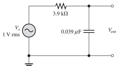
35. El circuito de retraso de la figura 15-91 también actúa como filtro pasabajas. Trace una curva de respuesta para este circuito marcando el voltaje de salida contra la frecuencia de 0 Hz a 10 kHz en incrementos de 1 kHz.
