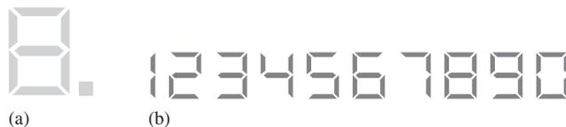
**Resolución** La **resolución** de un multímetro digital es el incremento más pequeño de una cantidad que el medidor puede medir. Mientras más pequeño es el incremento, mejor es la resolución. Un factor que determina la resolución de un medidor es el número de dígitos que aparecen en pantalla.
