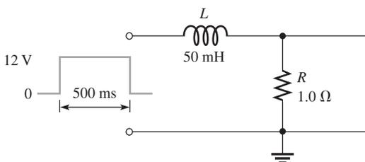
20. Determine la constante de tiempo en la figura 20-68. ¿Es un integrador o un diferenciador este circuito?
