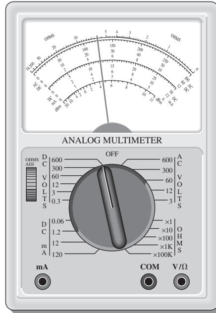
44. ¿Cuánta resistencia está midiendo el ohmmetro de la figura 2-75?
