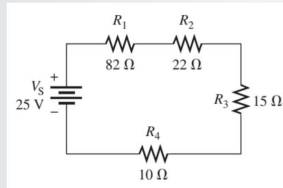
**Solución** El voltaje de la fuente \$V\_S\$ y la resistencia total \$R\_T\$ determinan la corriente. Primero, calcule la resistencia total.
