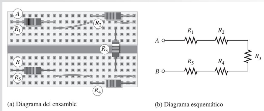
**Problema relacionado\*** (a) Muestre la forma en que usted reconectaría la tarjeta prototipo de la figura 5-4(a) de modo que todos resistores de número impar aparecieran primero, seguidos por los de número par. (b) Determine el valor de resistencia de cada resistor.
