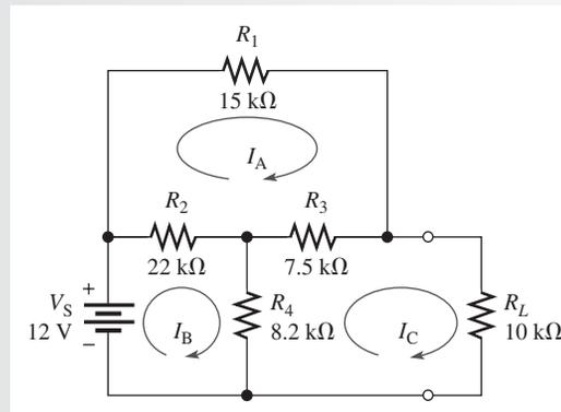
**Solución** Asigne tres corrientes de lazo en el sentido de las manecillas del reloj ( $I_A$ ,  $I_B$  e  $I_C$ ) como indica la figura 9-14. Escriba las ecuaciones de lazo, pero elimine el prefijo k de las resistencias. La corriente estará en mA.
