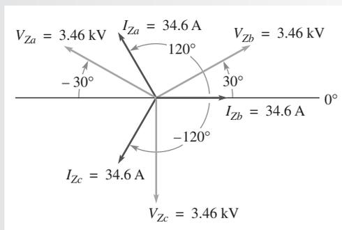
**Problema relacionado** Determine las corrientes de carga en la figura 21-26 si los voltajes de fase tienen magnitud de 240 V.
