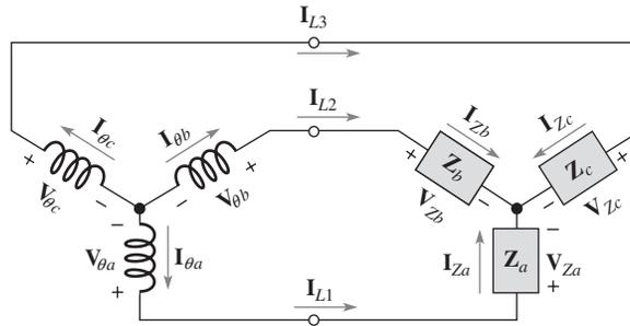
Observe en el sistema Y-Y de la figura 21-23 que la corriente de fase, la corriente de línea, y la corriente de carga son iguales en cada fase. Asimismo, cada voltaje de carga es igual al voltaje de fase correspondiente. Estas relaciones se expresan como sigue y son válidas para carga balanceada o desbalanceada.
