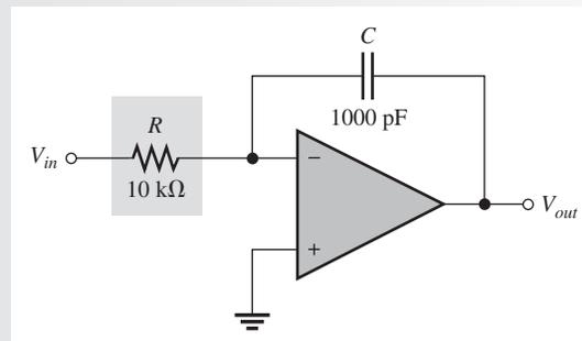
**Solución** Suponga que el valor del capacitor conmutado es de 1000 pF. Usted desea que el capacitor conmutado emule un resistor de 10 k $\Omega$  y proporcione efectivamente la misma corriente promedio que el resistor real. Utilizando la fórmula  $R = T/C$ ,
