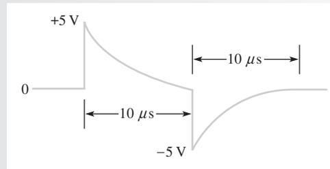
**Problema relacionado** Trace el voltaje de salida si el ancho de pulso se reduce a 5 μs en la figura 20-43.
