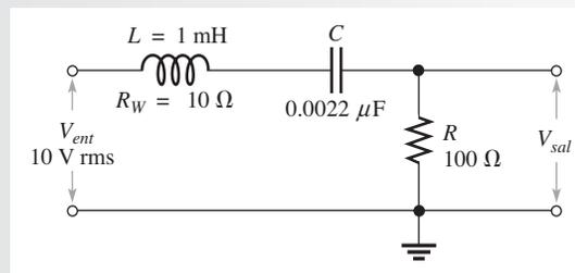
**Solución** En  $f_0$ , la impedancia del circuito resonante es igual a la resistencia de devanado,  $R_W$ . Según la fórmula del divisor de voltaje,
