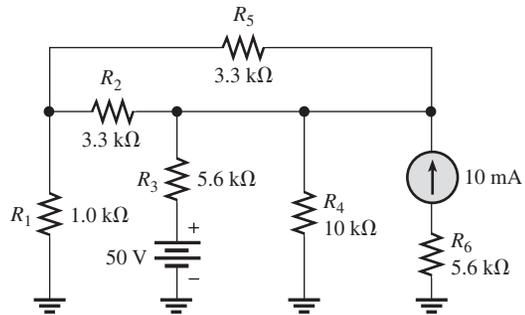
19. Determine el equivalente de Thevenin para el circuito externo al amplificador de la figura 8-79.
