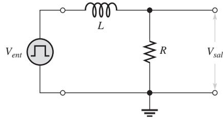
Como se sabe, cada borde de un pulso ideal se considera instantáneo. Dos reglas básicas para el comportamiento del inductor nos ayudarán a analizar las respuestas de circuitos  $RL$  a entradas de pulsos.
