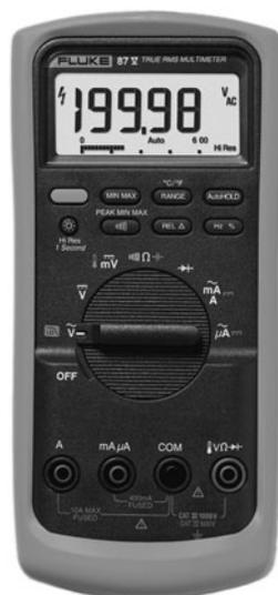
(a) Multímetro digital
