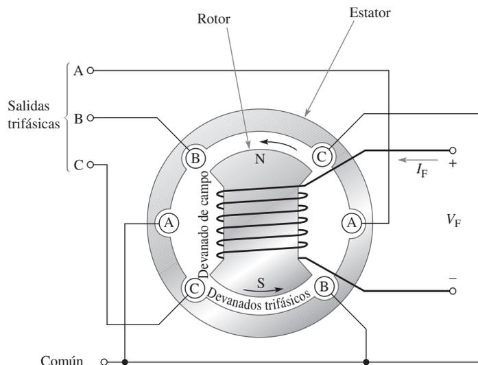
La corriente directa se aplica por medio de un ensamble de escobillas y un anillo rozante. La parte externa estacionaria del generador se llama **estator**. Tres devanados distintos están colocados a 120° uno de otro alrededor del estator; en estos devanados se inducen voltajes trifásicos a medida que el campo magnético gira, como indica la figura 21-1(b)
