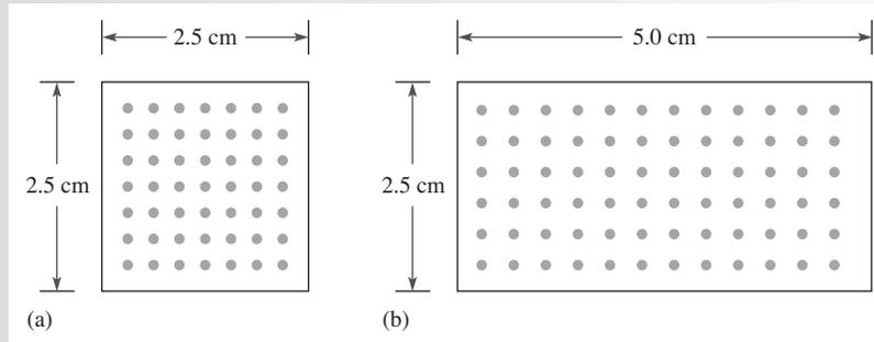
**Solución** El flujo es simplemente el número de líneas. En la figura 10-4(a) hay 49 puntos. Cada punto representa 1  $\mu\text{Wb}$ , así que el flujo es de 49  $\mu\text{Wb}$ . En la figura 10-4(b) hay 72 puntos, entonces el flujo es de 72  $\mu\text{Wb}$ .
