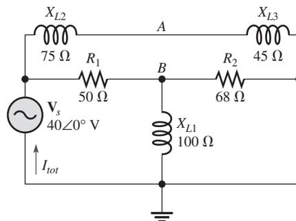
33. Determine el desplazamiento de fase y la atenuación (relación de  $V_{sal}$  a  $V_{ent}$ ) desde la entrada hasta la salida en el circuito de la figura 16-71.
