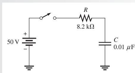
**Solución** La constante de tiempo es  $RC = (8.2 \text{ k}\Omega)(0.01 \mu\text{F}) = 82 \mu\text{s}$ . El voltaje con el cual el capacitor se cargará por completo es de 50 V (éste es  $V_F$ ). El voltaje inicial es cero. Advierta que  $50 \mu\text{s}$  es menor que una constante de tiempo; así que el capacitor se cargará menos que un 63% del voltaje total en tal tiempo.
