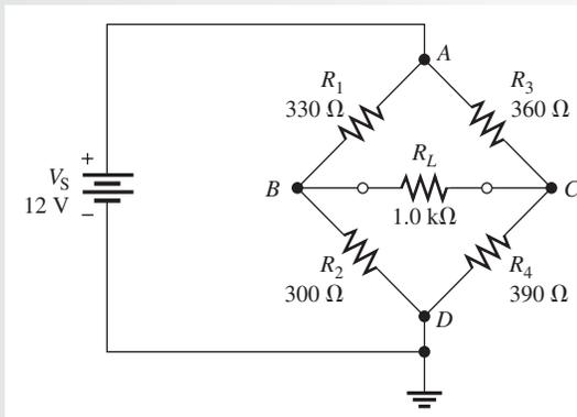
**Solución** Aplique la ley de la corriente de Kirchhoff en los nodos  $B$  y  $C$  en función de voltajes de nodo. Para mantener los coeficientes más manejables, todas las resistencias se muestran en  $k\Omega$ ; la corriente estará en mA.
