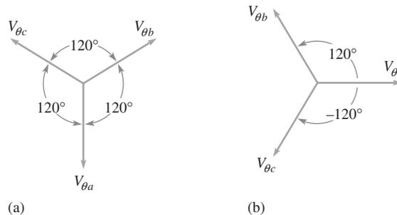
Hay tres voltajes de línea: uno entre  $a$  y  $b$ , uno entre  $a$  y  $c$ , y otro entre  $b$  y  $c$ . Es posible demostrar que la magnitud de cada voltaje de línea es igual a  $\sqrt{3}$  veces la magnitud del voltaje de fase y que hay un ángulo de fase de  $30^\circ$  entre cada voltaje de línea y el voltaje de fase más cercano.
