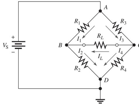
se elige casi siempre como el nodo de referencia, y el nodo *A* tiene el mismo potencial que el voltaje de fuente. Cuando se constituyen las ecuaciones para los dos voltajes de nodo desconocidos (*B* y *C*), es necesario especificar la dirección de la corriente como se describe en los pasos generales. La dirección de la corriente en  $R_L$  depende de las resistencias del puente; si la dirección asignada es incorrecta, la corriente aparecerá como negativa en la solución.
