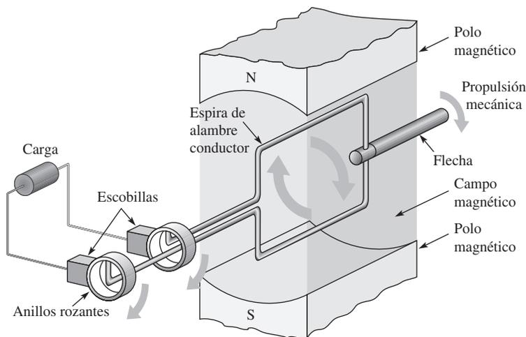
Como se aprendió en el capítulo 10, cuando un conductor se mueve a través de un campo magnético, se induce un voltaje. La figura 11-11 ilustra cómo es producido un voltaje sinusoidal por el generador de ca básico a medida que la espira gira. Se utiliza un osciloscopio para visualizar la forma de onda del voltaje.
