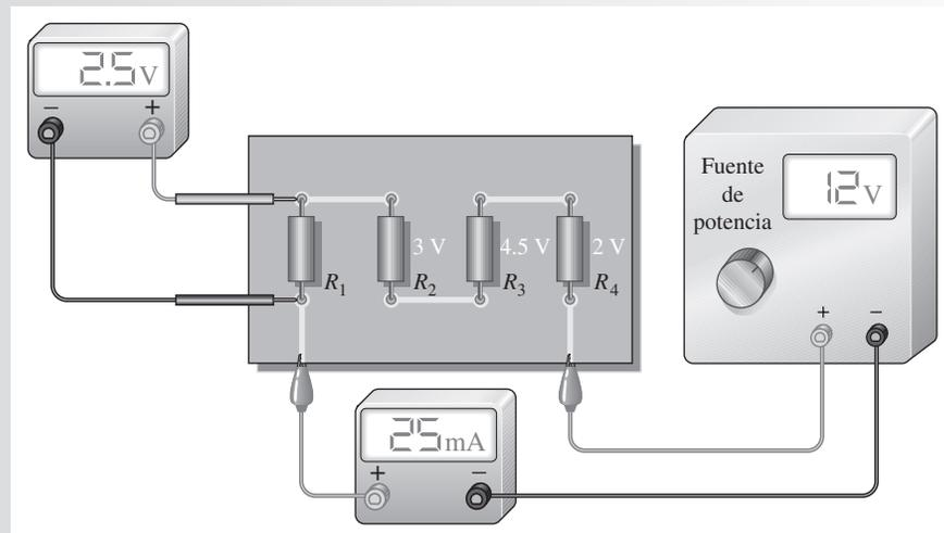
Determine la resistencia de cada resistor sustituyendo los valores de corriente y voltaje medidos en la fórmula de la ley de Ohm.
