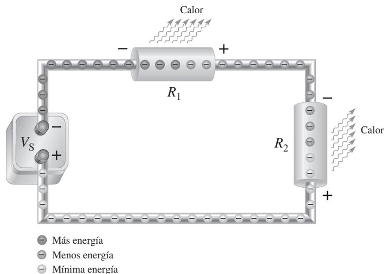
Recuerde que voltaje es igual a energía por carga ( $V = W/Q$ ), y la carga es una propiedad de los electrones. Con base en el voltaje de la batería, cierta cantidad de energía es impartida a todos los electrones que salen de la terminal negativa. Igual cantidad de electrones fluye en cada punto por todo el circuito, pero su energía disminuye a medida que se mueven a través de la resistencia del circuito.
