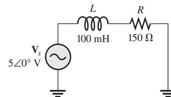
16. Determine la magnitud y el ángulo de fase del voltaje de fuente en la figura 16-60.
