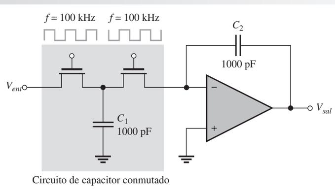
**Problema relacionado** ¿A qué frecuencia deben ser operados los interruptores de transistor en la figura 12-61 para emular un resistor de 5.6 k $\Omega$ ?
