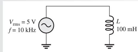
**Solución** Convierta 10 kHz en  $10 \times 10^3$  Hz y 100 mH en  $100 \times 10^{-3}$  H. En seguida calcule  $X_L$ .
