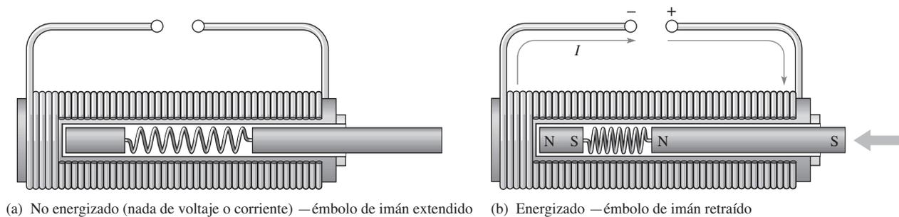
(a) No energizado (nada de voltaje o corriente) — émbolo de imán extendido (b) Energizado — émbolo de imán retraído
