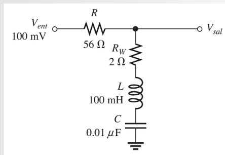
**Solución** Como  $X_L = X_C$  en condición de resonancia, el voltaje de salida es
