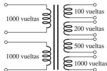
\*31. Para el transformador cargado con tomas que muestra la figura 14-55, determine lo siguiente:
