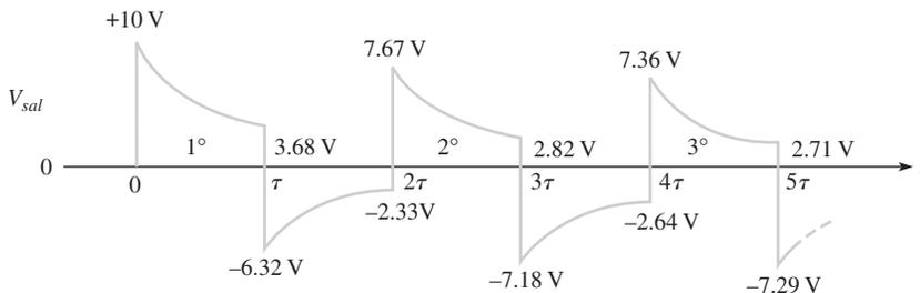
**Primer pulso** En el flanco ascendente, la salida salta al instante a +10 V. En seguida el capacitor se carga parcialmente al 63.2% de 10 V, que son 6.32 V. Por tanto, el voltaje de salida debe disminuir a 3.68 V, como indica la figura 20-31. En el flanco descendente, la salida realiza al instante una transición de 10 V hacia negativo a  $-6.32 \text{ V}$  ( $-10 \text{ V} + 3.68 \text{ V} = -6.32 \text{ V}$ ).
