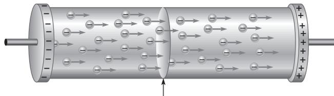
Cuando cierto número de electrones que tienen una carga total de 1 C pasan por un área de sección transversal en 1 s, la corriente es de 1 A.
