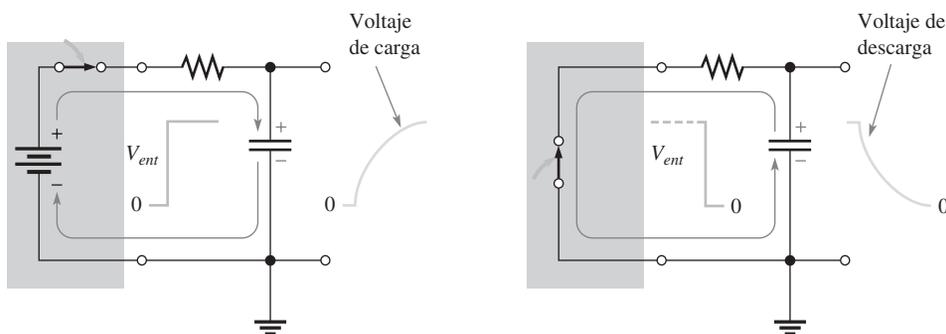
(a) Cuando el pulso de entrada se va a su NIVEL ALTO, la fuente actúa efectivamente como una batería en serie con un interruptor cerrado, así se carga el capacitor
