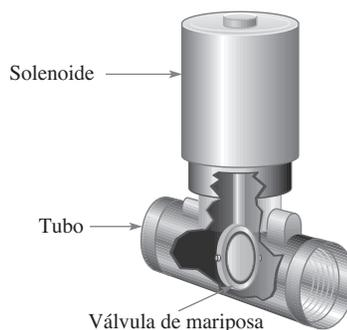
Están disponibles válvulas solenoide con una amplia variedad de configuraciones incluidas las válvulas normalmente abiertas o normalmente cerradas. Están clasificadas para diferentes tipos de fluidos (por ejemplo, gas o agua), presiones, número de trayectorias, tamaños, y más usos. La misma válvula puede controlar más de una línea y mover más de un solenoide.
