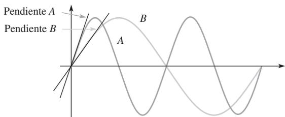
Cuando se incrementa la frecuencia,  $di/dt$  se incrementa, y por tanto  $v_{ind}$  aumenta. Cuando la frecuencia disminuye,  $di/dt$  disminuye, y por tanto  $v_{ind}$  disminuye. El voltaje inducido depende directamente de la frecuencia,
