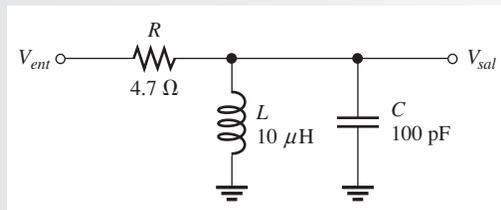
**Solución** La frecuencia central del filtro es su frecuencia resonante.
