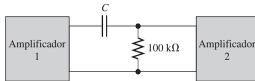
64. El valor rms del voltaje de señal que sale del amplificador A en la figura 15-105 es de 50 mV. Si la resistencia de entrada al amplificador B es de  $10 \text{ k}\Omega$ , ¿qué tanto de la señal se pierde debido al capacitor de acoplamiento cuando la frecuencia es de 3 kHz?
