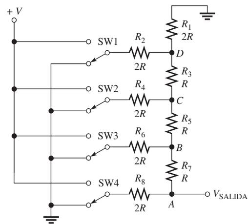
Los interruptores utilizados en esta ilustración simulan las entradas digitales (de dos niveles). Una posición del interruptor se conecta a tierra (0 V) y la otra a un voltaje positivo (V). El análisis es como sigue: se inicia suponiendo que, en la figura 7-43, el interruptor SW4 está en la posición V y los demás interruptores están en tierra, de modo que las entradas son las mostradas en la figura 7-44(a).
