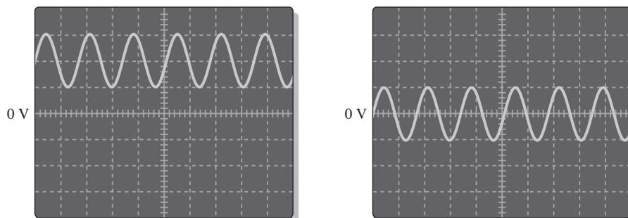
(a) Forma de onda de CD acoplada (b) Forma de onda de CA acoplada
