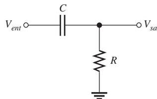
Cuando la frecuencia de entrada alcanza su valor crítico,  $X_C = R$  y el voltaje de salida es de  $0.707V_{ent}$ , como en el caso del filtro pasabajos. Conforme la frecuencia de entrada se incrementa
