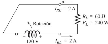
La corriente total que debe ser suministrada por el generador a la carga es de  $2 \angle 0^\circ \text{ A}$ . Esto significa que cada uno de los dos conductores que transportan corriente hasta y desde la carga debe ser capaz de manejar 2 A; por tanto, el total de la sección transversal de cobre debe manejar 4 A. (La sección transversal de cobre mide la cantidad total de alambre requerido con base en su tamaño físico en relación con su diámetro.) La potencia total suministrada a la carga es
