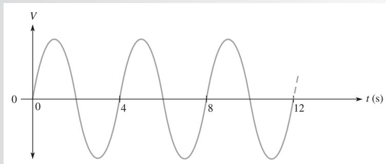
**Solución** Como se muestra en la figura 11-5, se requieren cuatro segundos (4 s) para completar cada ciclo. Por consiguiente, el periodo es de 4 s.
