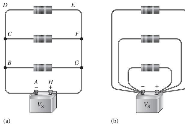
En la figura 6-8, una batería de 12 V está conectada por medio de tres resistores en paralelo. Cuando se mide el voltaje a través de la batería y luego a través de cada uno de los resistores, las lecturas son las mismas. Como se puede advertir, en un circuito en paralelo aparece el mismo voltaje a través de cada rama.
