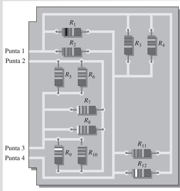
**Solución** En la tarjeta hay dos circuitos en paralelo distintos. El circuito entre las puntas 1 y 4 se revisa como sigue (asumiendo que uno de los resistores está abierto).
