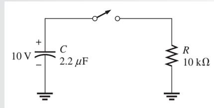
**Solución** La constante de tiempo de descarga es  $RC = (10 \text{ k}\Omega)(2.2 \mu\text{F}) = 22 \text{ ms}$ . El voltaje inicial en el capacitor es de 10 V. Advierta que 6 ms es menor que una constante de tiempo, de modo que el capacitor se descargará menos del 63%. Por consiguiente, tendrá un voltaje mayor que el 37% del voltaje inicial a los 6 ms.
