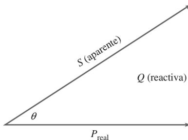
Recuerde que el factor de potencia es igual al coseno de  $\theta$  ( $FP = \cos \theta$ ). Conforme el ángulo de fase entre el voltaje aplicado y la corriente total se incrementa, el factor de potencia disminuye, lo que indica un circuito crecientemente reactivo. Un factor de potencia menor indica menos potencia real y más potencia reactiva.
