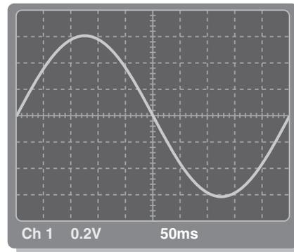
\*44. Con base en los ajustes del instrumento y en un examen de la pantalla del osciloscopio y de la tarjeta prototipo mostrados en la figura 11-90, determine la frecuencia y el valor pico de las señales de entrada y salida. La forma de onda mostrada es el canal 1. Trace la forma de onda del canal 2 como aparecería en el osciloscopio con los ajustes indicados.
