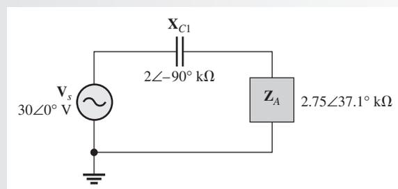
A continuación, use el principio del divisor de voltaje para determinar ( $V_A$ ) en el punto A en la figura 17-33. La impedancia total es
