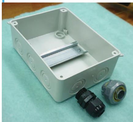
4. Con un cutter realiza el orificio de acuerdo al diametro de los conectores.
