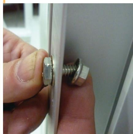
12. Inserta otro terminador pero este atravesara el cable pelón y aprieta la pieza con las pinzas.
