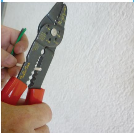
64. En los cables pelados. Introduce el terminador y aprieta la pinza fuertemente.
