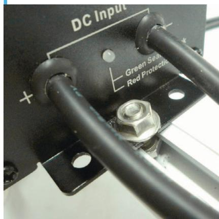
40. Fija ambos inversores de la misma manera. (Cerca de la caja posterior del panel)
