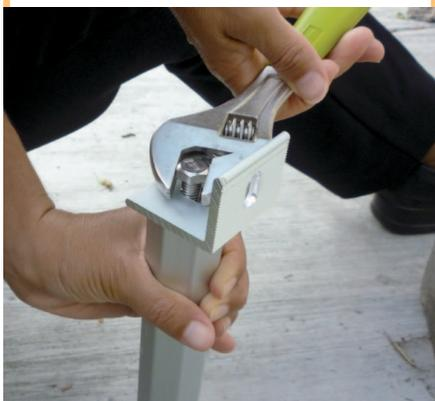
5. Inserta otro tornillo del mismo tamaño en el riel y aprieta con una tuerca de 3/8. El riel debe juntarse al lado ranurado de la "L" para mayor fricción y seguridad. Ambas piezas deben quedar alineadas en la parte superior.
