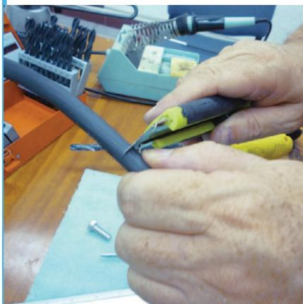
18. Corta aproximadamente un centímetro de la cubierta de cada cable.
