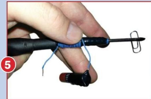
5 Colocamos el cable con la pila de la siguiente manera, y ponemos cinta para evitar que se salga.
