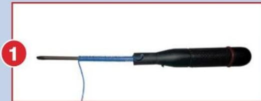
1 Tomamos el destornillador y comenzamos a enrollar el cable con un diámetro de 40 mm.
