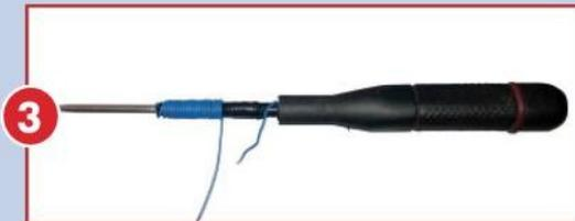
3 Bobinamos en sentido contrario sobre la primera capa hasta llegar al principio.
