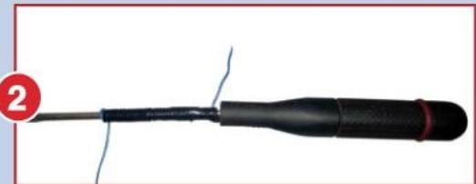
2 Colocamos una capa de cinta aisladora para evitar que se nos desarme.
