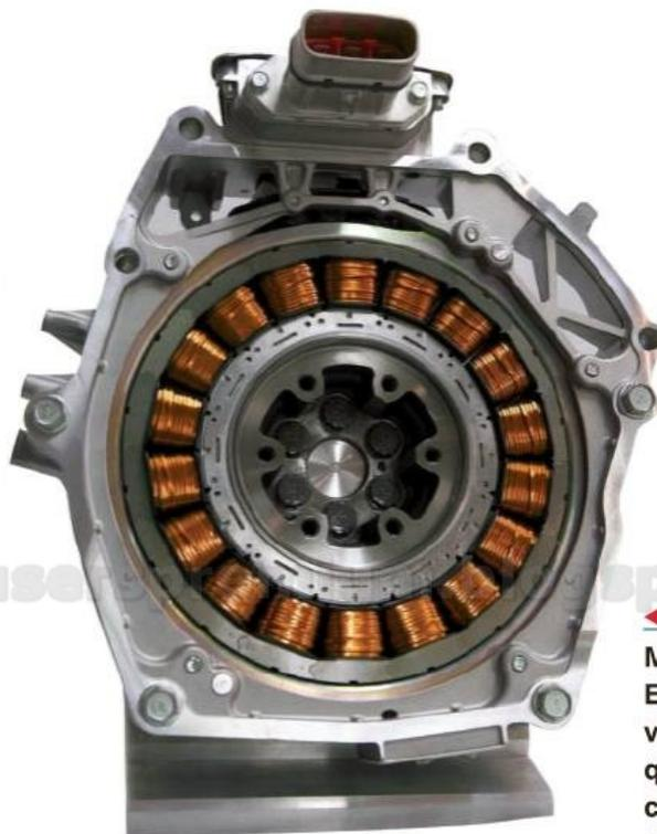
Motor eléctrico. En él podemos ver los bobinados que generan el campo magnético necesario para su funcionamiento.
